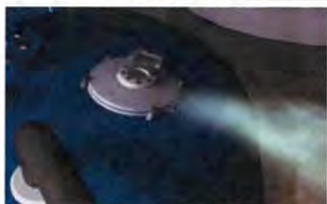
รูปที่ 1. ใจากกระบวนการผลิตรั่วจากช่องสำหรับคนเข้า (manway)
