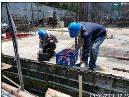
ภาพที่ 64 การตรวจวัดการเคลื่อนตัวของดิน
