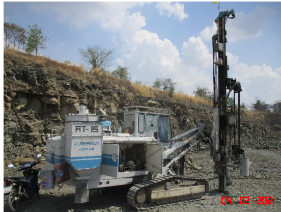
รูปที่ 2-6 เครื่องเจาะรูระเบิดที่มีอุปกรณ์เก็บฝุ่นติดไว้ที่หัวเจาะ
