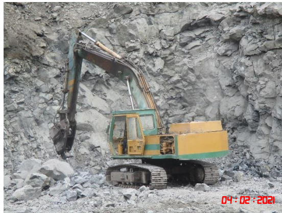
รูปที่ 2-7 การเจาะกระแทกย่อยแร่ให้มีขนาดเล็กลง
