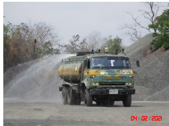
รูปที่ 2-12 การฉีดพรมน้ำเพื่อลดการฟุ้งกระจายของฝุ่นละออง
