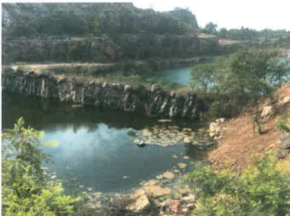
รูปที่ 5 Sump รองรับน้ำขุ่นข้นและตะกอนดินบริเวณหน้าเหมือง
