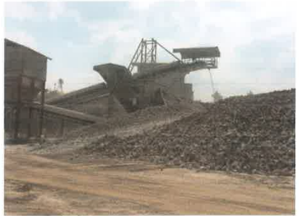
รูปที่ 10 การปิดคลุมอาคารโรงไม้หิน ชุด Hopper และ Primary Crusher
