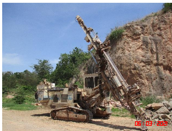
รูปที่ 2-12 เครื่องเจาะรูระเบิดที่มีอุปกรณ์เก็บฝุ่นติดตั้งไว้บริเวณหัวเจาะ
