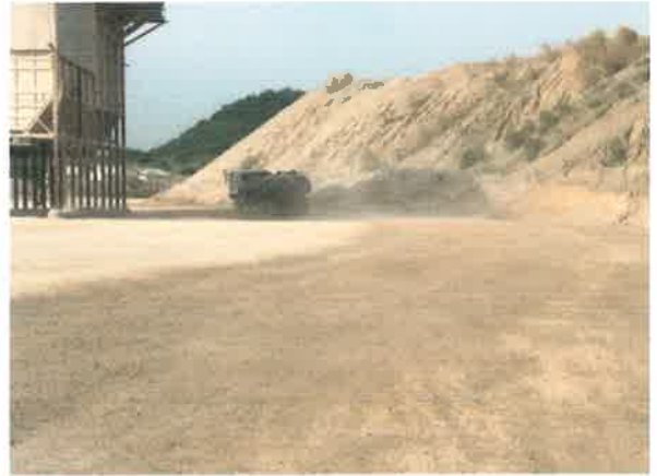
รูปที่ 4 เปลือกดินจากหน้าเหมื่อนำมาผสมเป็นหินคลุก
