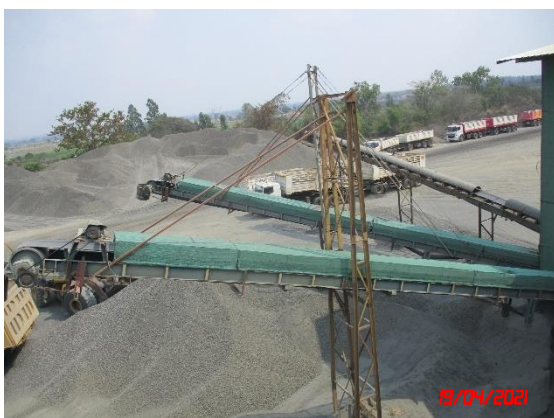
รูปที่ 2-15 หลังคาปิดคลุมสายพานลำเลียง
