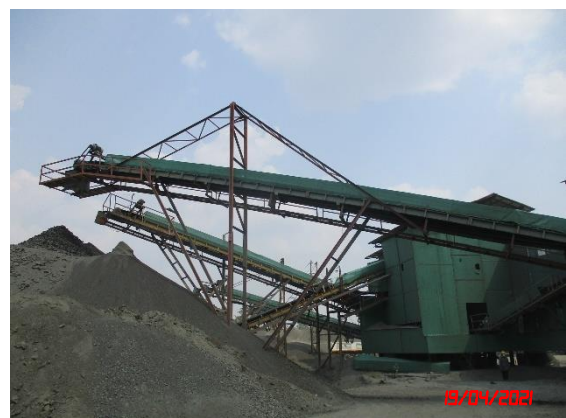
รูปที่ 2-15 หลังคาปิดคลุมสายพานลำเลียง
