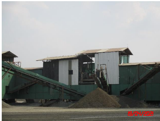
รูปที่ 2-15 หลังคาปิดคลุมสายพานลำเลียง
