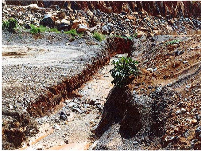
รูปที่ 11 ร่องระบายน้ำล้อมรอบพื้นที่ทำเหมือง
