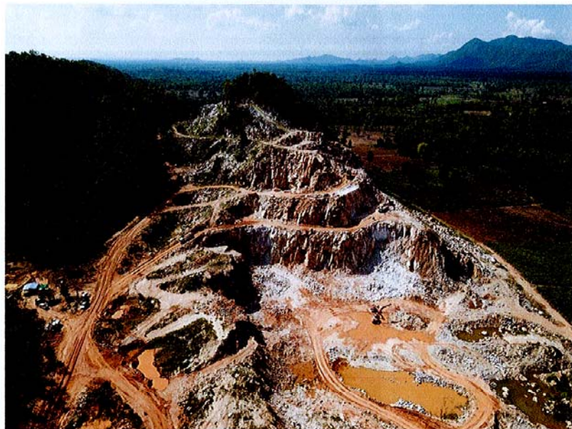
รูปที่ 8 แสดงสภาพพื้นที่หน้าเหมืองบริเวณด้านทิศตะวันออกของประทานบัตร เดินหน้าเหมืองไปทางทิศเหนือ มีการทำเหมืองเป็นแบบชั้นบันได
