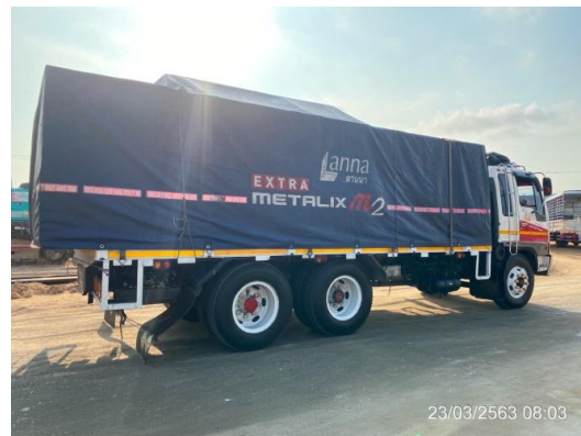
รูปที่ 3-2 การปิดคลุม/ผูกมัดในส่วนบรรทุก ของรถบรรทุก
