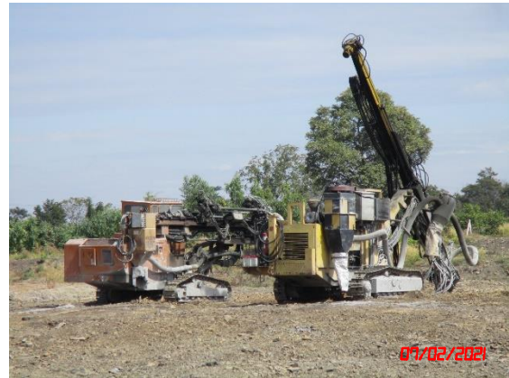
รูปที่ 2-22 เครื่องเจาะระเบิดที่มีอุปกรณ์เก็บฝุ่นติดไว้กับหัวเจาะ
