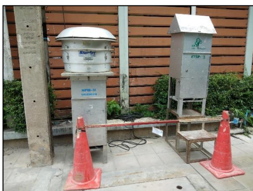
ภาพที่ 4.4-1 การตรวจวัดคุณภาพอากาศในบรรยากาศ (ทิศเหนือของโครงการ)
