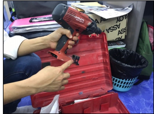
ภาพที่ 68 อุปกรณ์ลดแรงสั่นสะเทือน
