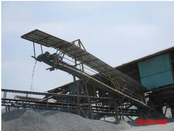
รูปที่ 2-17 อาคารปิดคลุมสายพานลำเลียง
