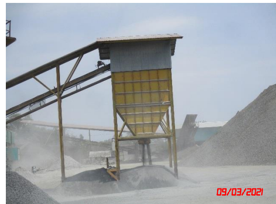
รูปที่ 2-16 อาคารปิดคลุมโรงม่หิน 3 ด้าน
