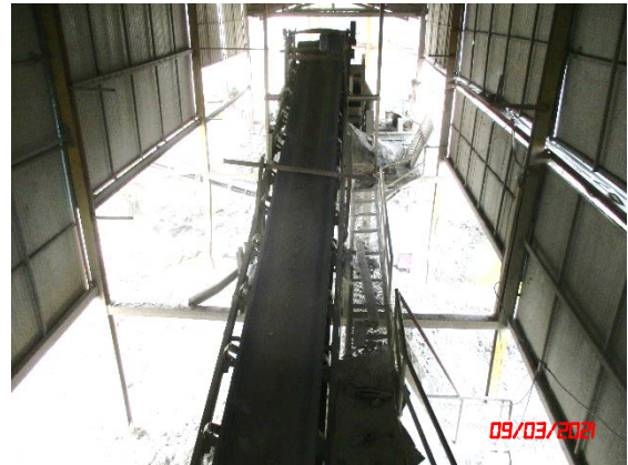
รูปที่ 2-17 อาคารปิดคลุมสายพานลำเลียง
