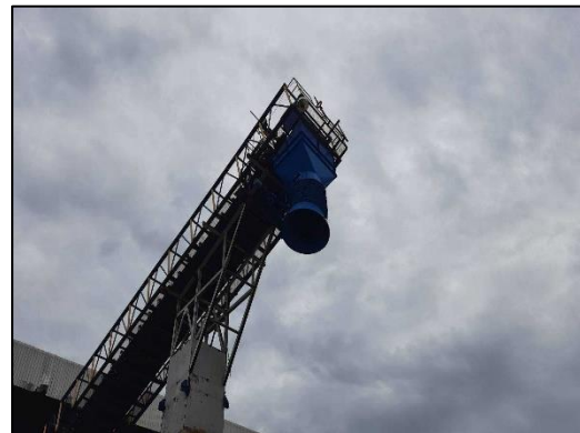
ภาพที่ 3 ท่อ (Chute) ต่อจากปลายสายพานลำเลียงลง มายังกองขานอ้อย
