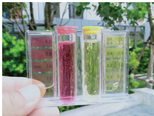
ภาพที่ 3.5.4-1 การตรวจวัด pH และ Cl_2 สระว่ายน้ำ
