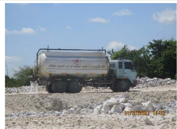
รูปที่ 3-28 การฉีดพรมน้ำบนถนนในเส้นทางขนแร่
