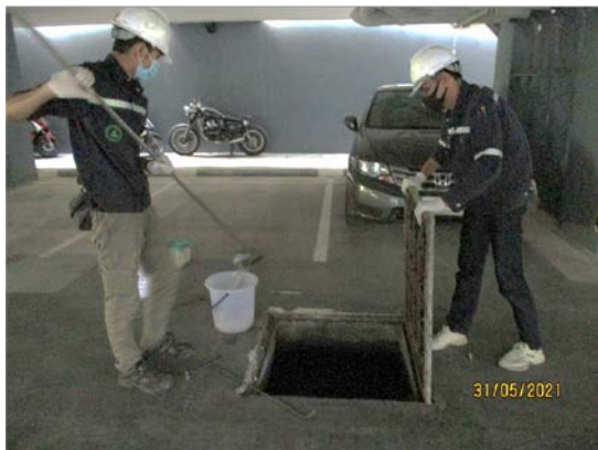
รูปที่ 3-4 คุณภาพน้ำทิ้งก่อนการบำบัด บริเวณบ่อปรับสภาพของระบบบำบัดน้ำเสียอาคาร B
