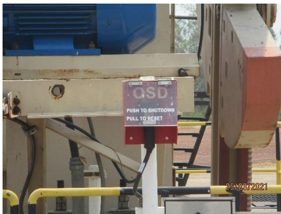
ภาพถ่ายที่ 2.2-4 อุปกรณ์หยุดการทำงานฉุกเฉิน (OSD/ESD)
