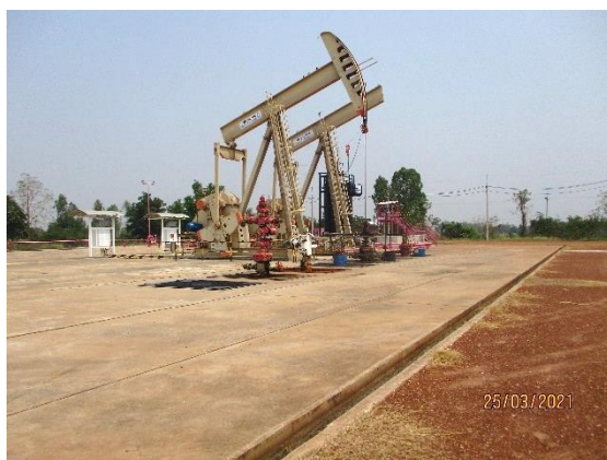
ภาพถ่ายที่ 2.2-5 การจัดวางและติดตั้งอุปกรณ์การผลิตและสารเคมีบนพื้นคอนกรีตที่มีรางระบายน้ำล้อมรอบ
