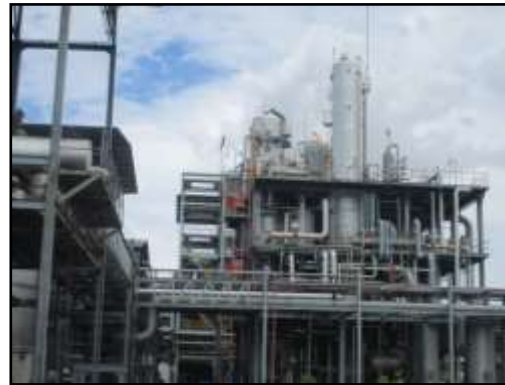
รูปที่ 2-9 ถังหมัก หอกลิ้น และหอกลั่นน้ำที่เป็นระบบปิด
