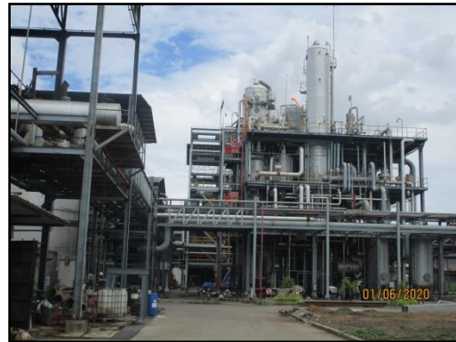
รูปที่ 2-8 ถังหมัก หกกลั่น และหอกลั่นน้ำที่เป็นระบบปิด
