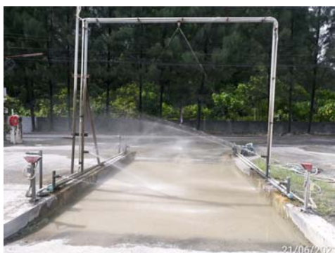
(7) ระบบฉีดล้างล้อและฉีดพรมหินก่อนออกจากโรงโม่หิน
