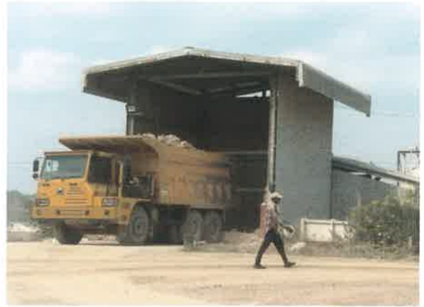
รูปที่ 8 การปิดคลุมอาคารโรงโม่หิน ชุด Hopper และ Primary Crusher
