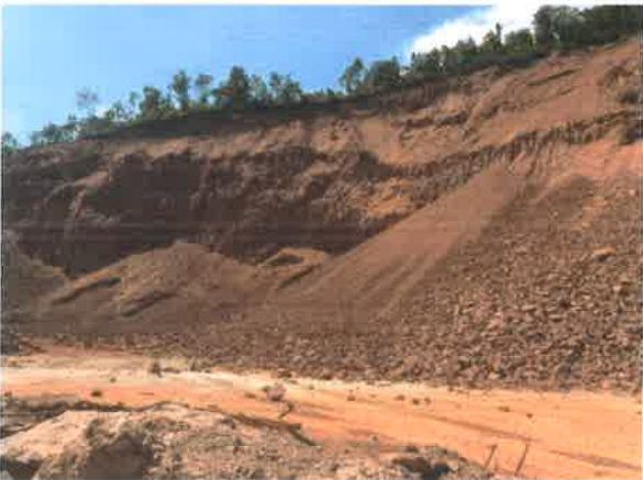
รูปที่ 3 เปลือกดินจากหน้าเหมืองจะนำไปผสมเพื่อผลิตเป็นหินคลุก
