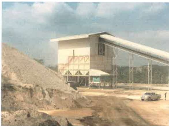
รูปที่ 3 เปลือกดินจากหน้าเหมืองนำมาผสม เป็นหินคลุก
