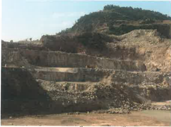
รูปที่ 1 การเปิดหน้าเหมืองเป็นขั้นบันได
