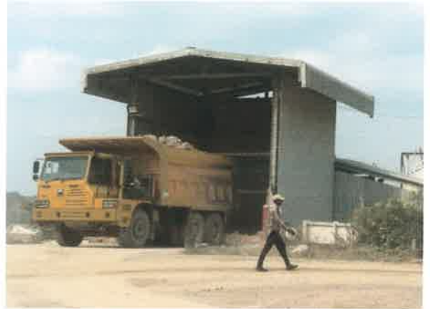
รูปที่ 8 การปิดคลุมอาคารโรงโม่หิน ชุด Hopper และ Primary Crusher
