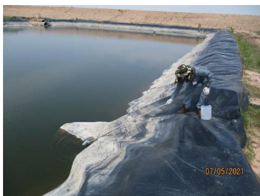
ภาพที่ 3.4.7-1 แสดงการเก็บตัวอย่างคุณภาพน้ำทิ้งจากบ่อกักน้ำทิ้งรวม ระหว่างเดือนมกราคม-มิถุนายน พ.ศ. 2564
