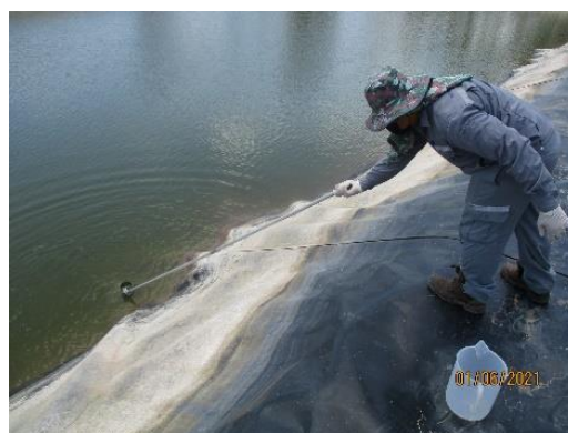
ภาพที่ 3.4.7-1 แสดงการเก็บตัวอย่างคุณภาพน้ำทิ้งจากบ่อกักน้ำทิ้งรวม ระหว่างเดือนมกราคม-มิถุนายน พ.ศ. 2564
