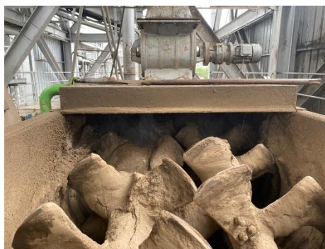
ภาพที่ 2-8 การฉีดพรมน้ำเพื่อลดการฟุ้งกระจายของเถ้า
