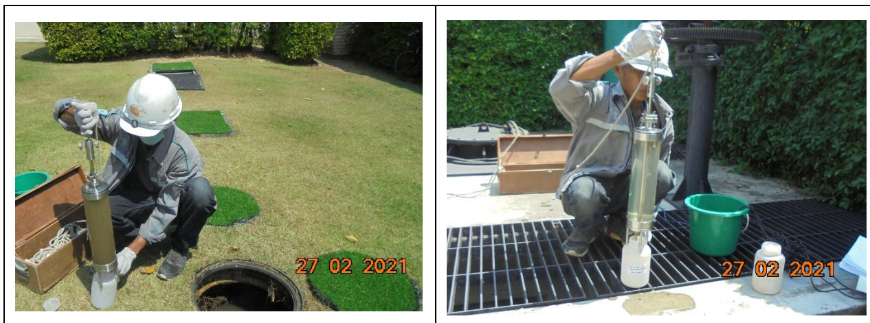
รูปที่ 2-17 การเก็บตัวอย่างน้ำจากระบบบำบัดน้ำเสีย
