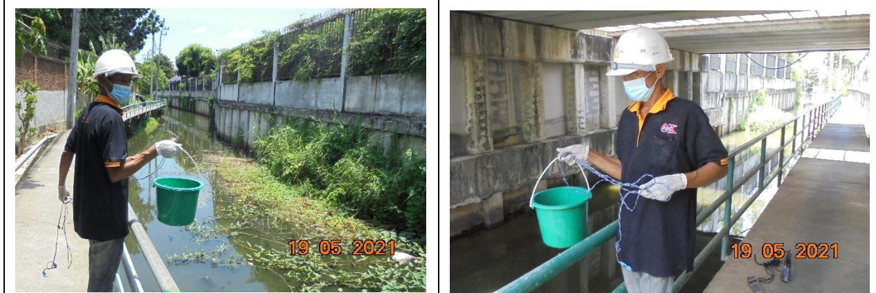
รูปที่ 2-18 การเก็บตัวอย่างน้ำผิวดินแหล่งรองรับน้ำทิ้งจากโครงการ
