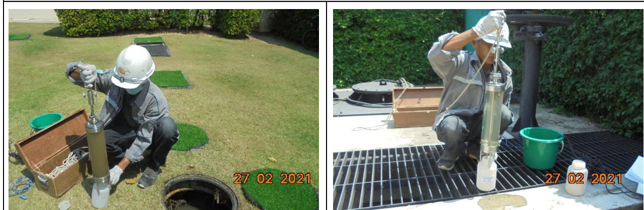
รูปที่ 2-12 การเก็บตัวอย่างน้ำก่อนและหลังการบำบัดไปทำการตรวจวิเคราะห์ในห้องปฏิบัติการ
