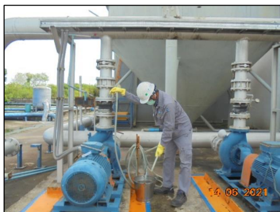
รูปที่ 3.8 การเก็บตัวอย่างน้ำทิ้งจากระบบบำบัดน้ำเสียแห่งที่ 2 (Sequencing Batch Reactor) บริเวณ Effluent
