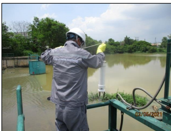
รูปที่ 3.13 การเก็บตัวอย่างคุณภาพน้ำผิวดิน บริเวณฝายกั้นน้ำในนิคมฯ (W2)
