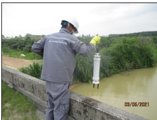
รูปที่ 3.15 การเก็บตัวอย่างคุณภาพน้ำผิวดิน บริเวณบ้านวังตาลหม่อน ได้ฝายกั้นในนิคมฯ (W4)
