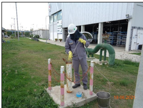
รูปที่ 3.20 การเก็บตัวอย่างน้ำใต้ดิน บริเวณก่อนไหลผ่าน Holding Pond 2
