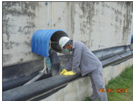
รูปที่ 3.10 การเก็บตัวอย่างน้ำทิ้งจากระบบบำบัดน้ำเสียแห่งที่ 4 (Sequencing Batch Reactor) บริเวณ Effluent
