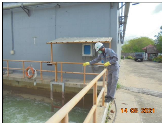
รูปที่ 3.7 การเก็บตัวอย่างน้ำทิ้งจากระบบบำบัดน้ำเสียแห่งที่ 2 (Sequencing Batch Reactor) บริเวณ Influent
