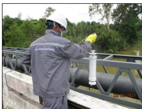
รูปที่ 3.14 การเก็บตัวอย่างคุณภาพน้ำผิวดิน บริเวณใต้ฝายกั้นน้ำในนิคมฯ (W3)
