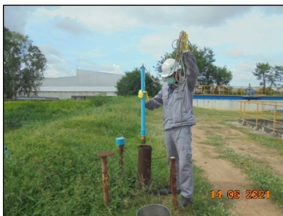
รูปที่ 3.18 การเก็บตัวอย่างน้ำใต้ดิน บริเวณก่อนไหลผ่าน Holding Pond 1
