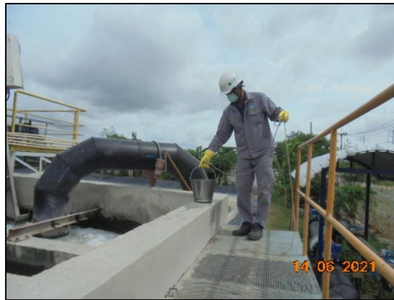
รูปที่ 3.9 การเก็บตัวอย่างน้ำทิ้งจากระบบบำบัดน้ำเสียแห่งที่ 4 (Sequencing Batch Reactor) บริเวณ Influent
