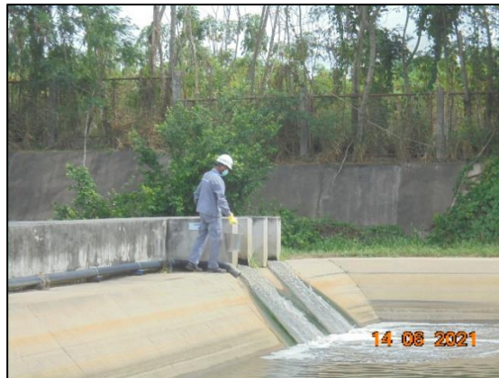
รูปที่ 3.6 การเก็บตัวอย่างน้ำทิ้งจากระบบบำบัดน้ำเสียแห่งที่ 1 (Activated Sludge) บริเวณ บ่อ Equalization Tank
