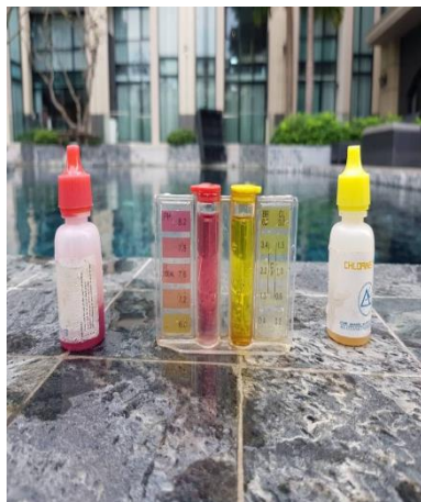
ภาพที่ 19 การวัดค่า PH และ CL ประจำวัน และรายงานน้ำสิ้นของสระว่ายน้ำ
