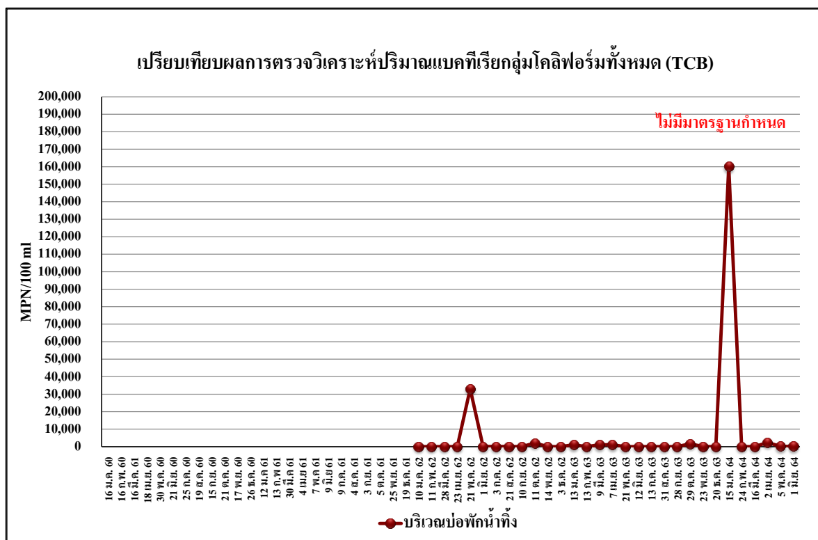
รูปที่ 5.3-51 เปรียบเทียบผลการตรวจวิเคราะห์ปริมาณแบคทีเรียกลุ่มโคลิฟอร์มทั้งหมด (TCB) บริเวณบ่อกักน้ำทิ้ง ระหว่างเดือนมกราคม 2560-มิถุนายน 2564
