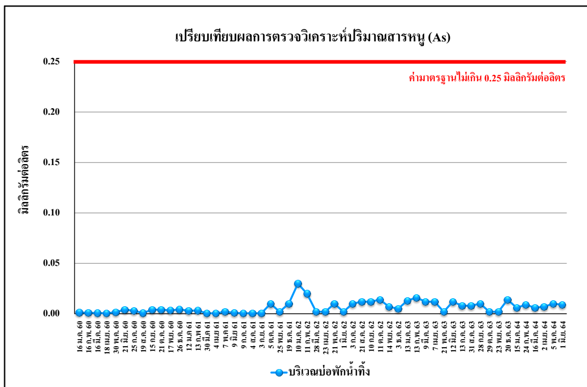
รูปที่ 5.3-47 เปรียบเทียบผลการตรวจวิเคราะห์ค่าสารหนู (As) บริเวณบ่อกักน้ำทิ้ง ระหว่างเดือนมกราคม 2560-มิถุนายน 2564
