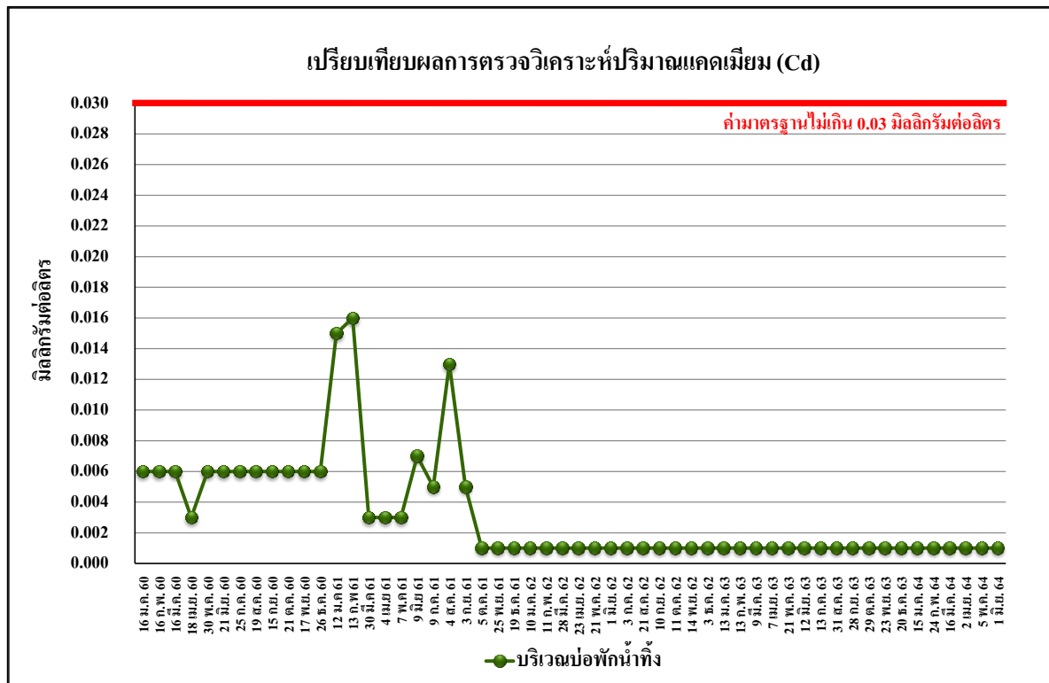
รูปที่ 5.3-46 เปรียบเทียบผลการตรวจวิเคราะห์ค่าแคดเมียม (Cd) บริเวณบ่อพักน้ำทิ้ง ระหว่างเดือนมกราคม 2560-มิถุนายน 2564
