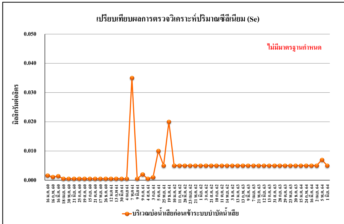
รูปที่ 5.3-27 เปรียบเทียบผลการตรวจวิเคราะห์ค่าซีลีเนียม (Se) บริเวณบ่อน้ำเสียก่อนเข้าระบบบำบัดน้ำเสีย ระหว่างเดือนมกราคม 2560-มิถุนายน 2564
