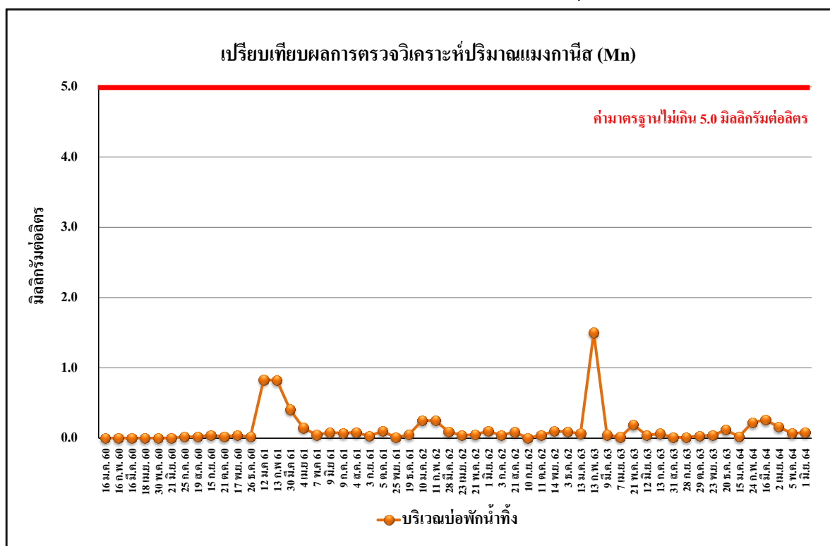
รูปที่ 5.3-42 เปรียบเทียบผลการตรวจวิเคราะห์ค่าแมงกานีส (Mn) บริเวณบ่อกักน้ำทิ้ง ระหว่างเดือนมกราคม 2560-มิถุนายน 2564
