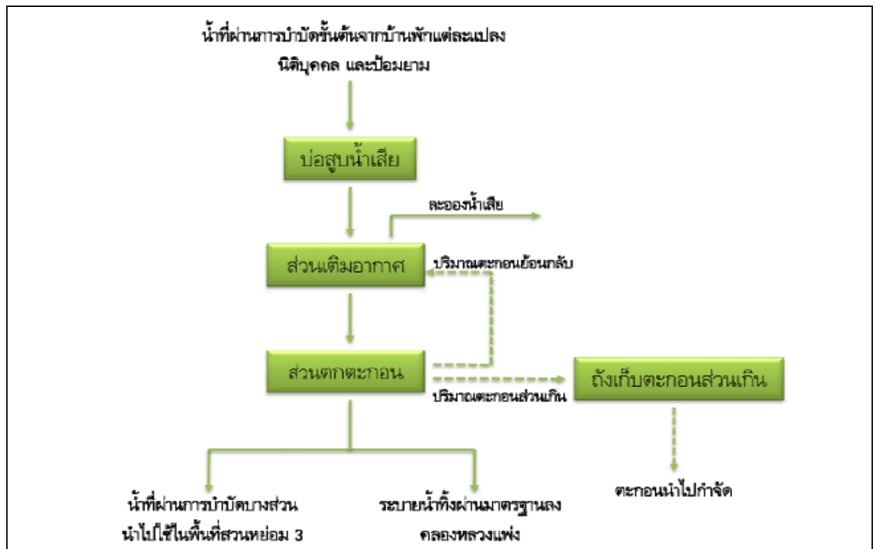
รูปที่ 1-6 ขั้นตอนการบำบัดน้ำเสียของระบบบำบัดน้ำเสียรวมรองรับพื้นที่ส่วนที่ 2 (จำนวน 2 ชุด)
