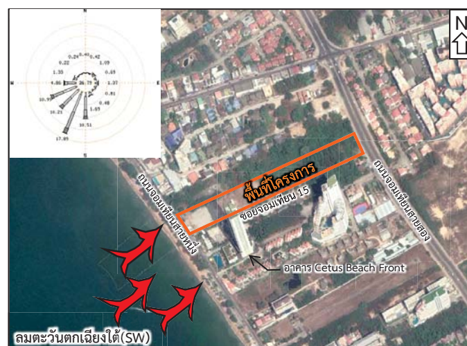
รูปที่ 4.2.4.5-1 : แบบจำลองทิศทางลมที่พัดผ่านพื้นที่โครงการเดือนมกราคม-มิถุนายน
