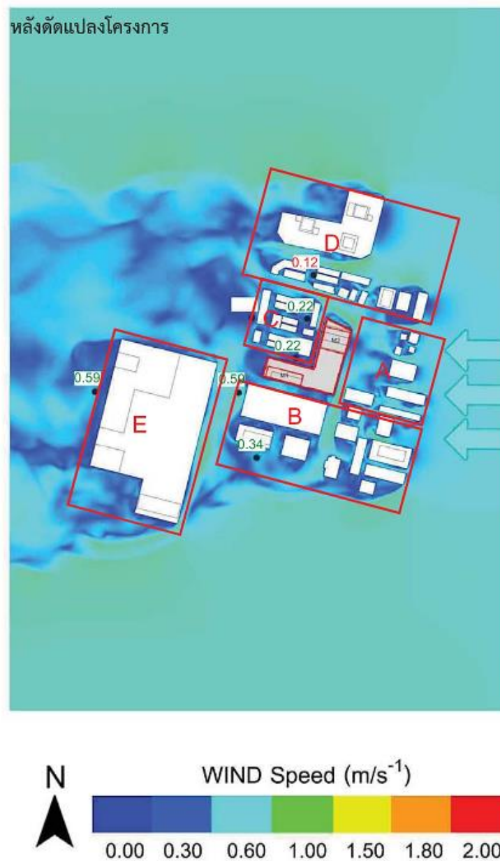
รูปที่ 4.2.4.6-6 : ภาพ 3 มิติจำลองลมจากทิศตะวันออก (เดือนตุลาคม-ธันวาคม) ก่อนและหลังแปลงอาคาร
