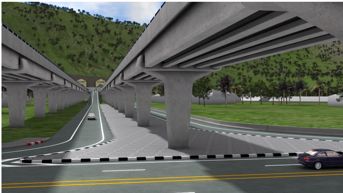
รูปที่ 1.2.4-4 โครงสร้างแบบคานคอนกรีตรูปตัวไอ (I-Girder)
