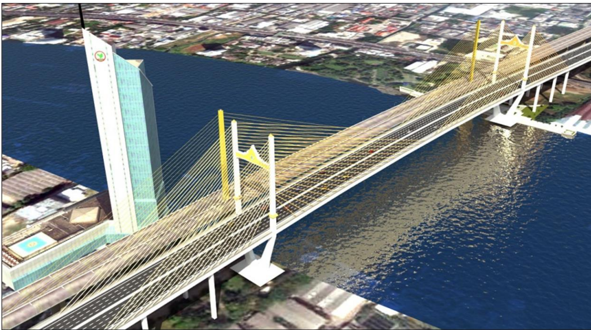
รูปที่ 2.4-3 รูปแบบโครงสร้างช่วงสะพานข้ามแม่น้ำเจ้าพระยา
