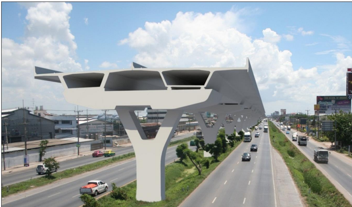
รูปที่ 2.4-1 รูปแบบโครงสร้างตามแนวเกาะกลางถนนพระรามที่ 2 ช่วงวงแหวนรอบนอกฯ ถึงดาวคะนอง
