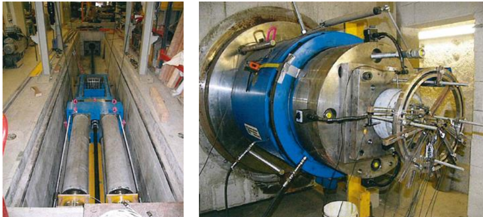
รูปที่ 2.10-2 ตัวอย่างการทดสอบความล้าของระบบเคเบิลในฐานะทดสอบและการติดตั้งอุปกรณ์การวัดที่หัวดึง
