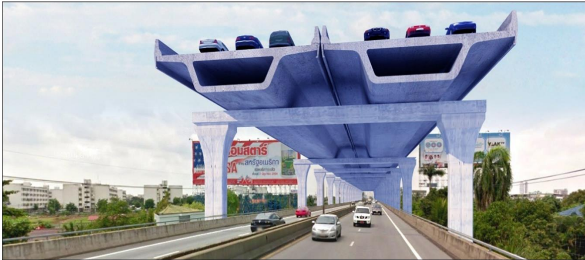
รูปที่ 2.4-2 รูปแบบการก่อสร้างโครงการซ้อนทับทางพิเศษเฉลิมมหานคร (เสาตอม่อแบบ Portal Frame) ช่วงดาวคะนองไปจนถึงสะพานคู่ขนานสะพานพระราม 9
