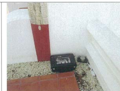
ตัวอย่างการติดตั้งเครื่องมือตรวจวัดความสั่นสะเทือน
