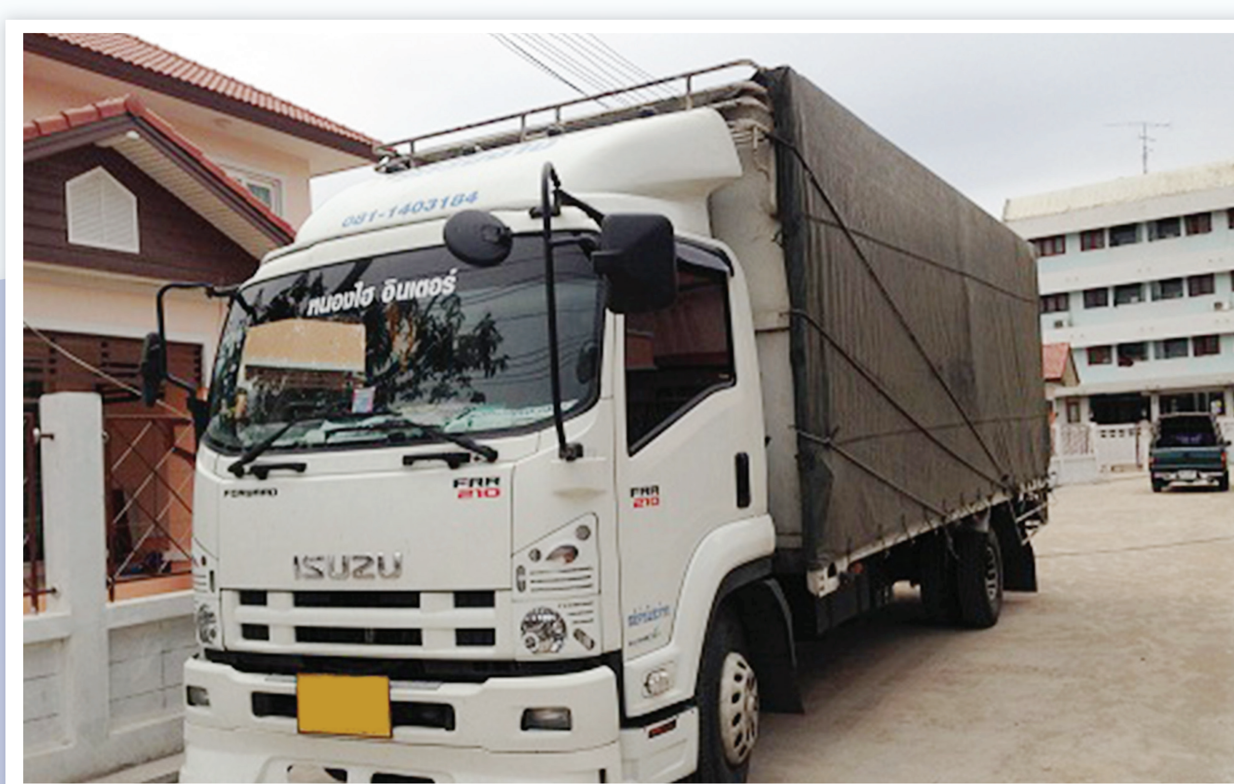
การปิดคลุมผ้าใบบรรทุกทุกชนิดก่อสร้าง
