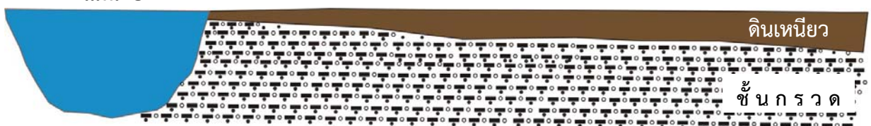
รูปที่ 5.2.7-3: ภาพตัดขวางแสดงชั้นดินเหนียวและชั้นกรวดทรายที่ติดกับแม่น้ำปิง
