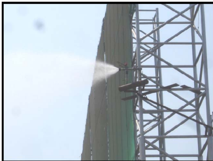
รูปที่ 2.5.3-3: ระบบหัวพ่นน้ำ (Sprinkler) ฉีดพรมกองขานอ้อย
