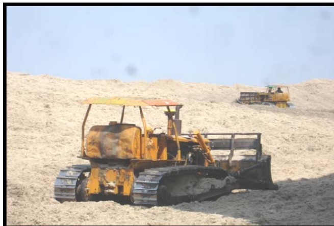
รูปที่ 2.5.3-5: การใช้รถแทรกเตอร์บดอัดขานอ้อย
