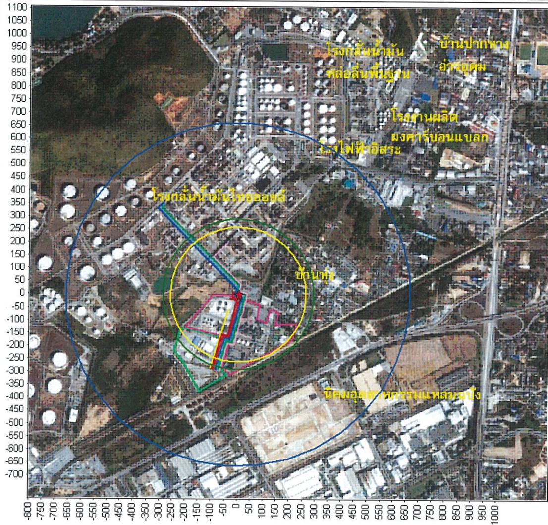
รูปที่ 5.7-19 รัศมีของผลกระทบจากแรงดัน กรณีเกิดการติดไฟและระเบิดในลักษณะ UVCE จากการรั่วไหลของ Blended Kerosene จากท่อขนส่ง ที่มีแนวท่อจากหน่วยผลิตของโครงการฯ ไปยังโรงกลั่นน้ำมันไทยออยล์ (บริเวณข้อต่อที่ 2) ในสภาพบรรยากาศแบบ F-Class (S-2L, 1.5/F)
