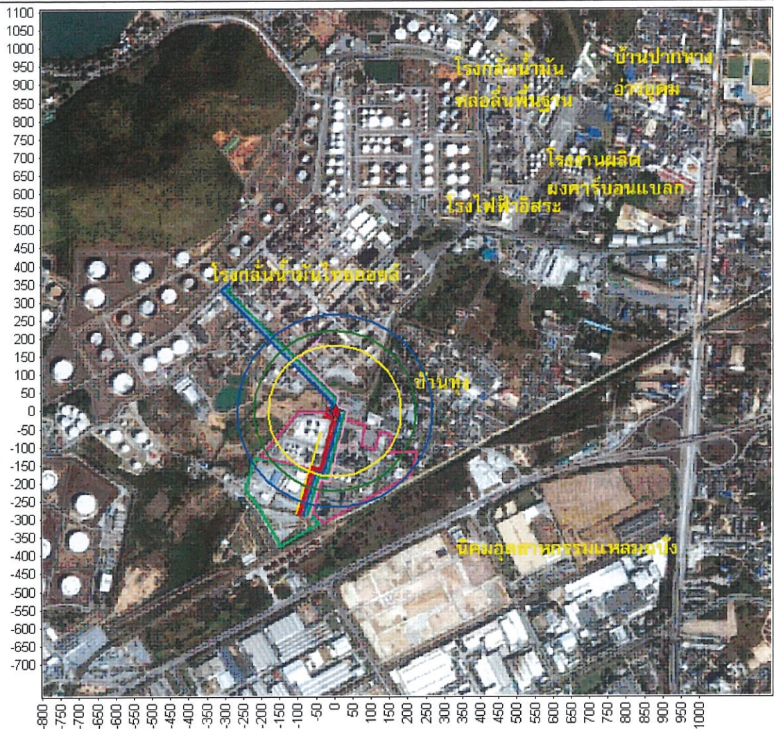
รูปที่ 5.7-15 รัศมีของผลกระทบจากความร้อน กรณีเกิดการติดไฟในลักษณะ Jet Fire จากการรั่วไหลของ Blended Kerosene จากท่อขนส่ง ที่มีแนวท่อจากหน่วยผลิตของโครงการฯ ไปยังโรงกลั่นน้ำมันไทยออยล์ (บริเวณข้อต่อที่ 2) ในสภาพบรรยากาศแบบ D-Class (S-2L, 5/D)
