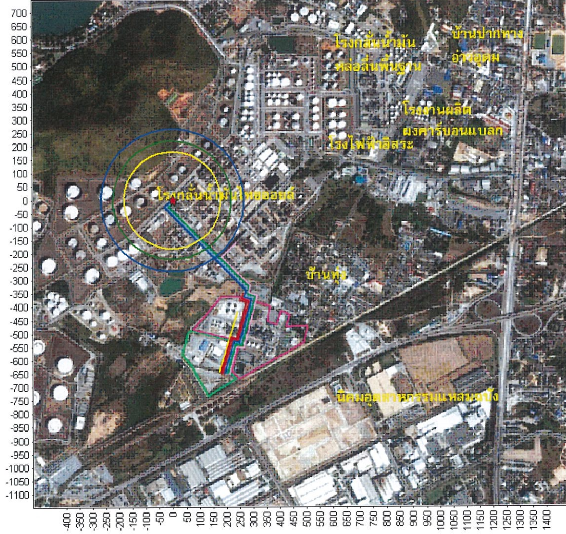
รูปที่ 5.7-16 รัศมีของผลกระทบจากความร้อน กรณีเกิดการติดไฟในลักษณะ Jet Fire จากการรั่วไหลของ Blended Kerosene จากท่อขนส่ง ที่มีแนวท่อจากหน่วยผลิตของโครงการฯ ไปยังโรงกลั่นน้ำมันไทยออยล์ (บริเวณเชื่อมต่อกับหน่วยผลิตของโรงกลั่นน้ำมันไทยออยล์) ในสภาพบรรยากาศแบบ D-Class (S-2L, 5/D)
