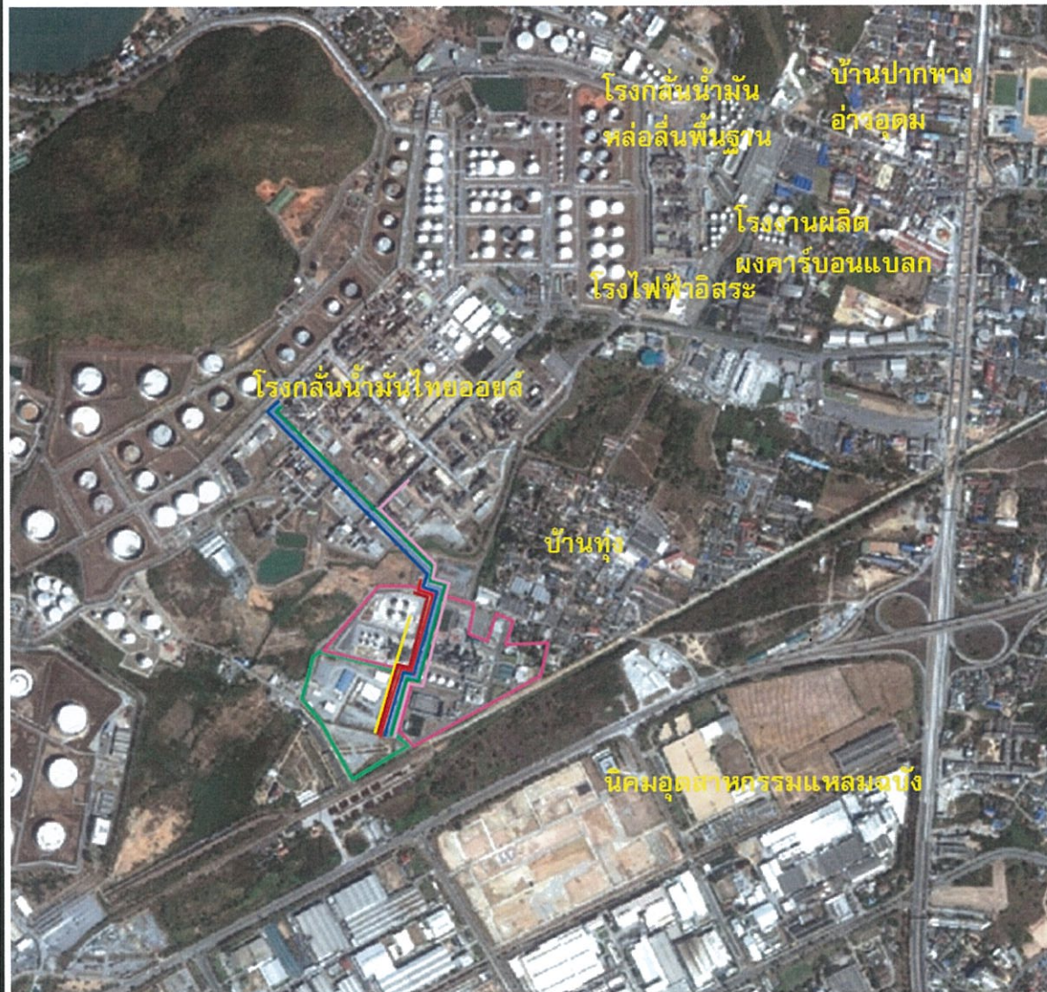
รูปที่ 5.7-1 แนวท่อขนส่งก๊าซธรรมชาติ ท่อขนส่งวัตถุดิบและสารเคมี ระหว่างโครงการผลิตสารตั้งต้นผลิตภัณฑ์ทำความสะอาดกับโรงกลั่นน้ำมันไทยออยล์ และโรงงานผลิตสารพาราไซลีน
