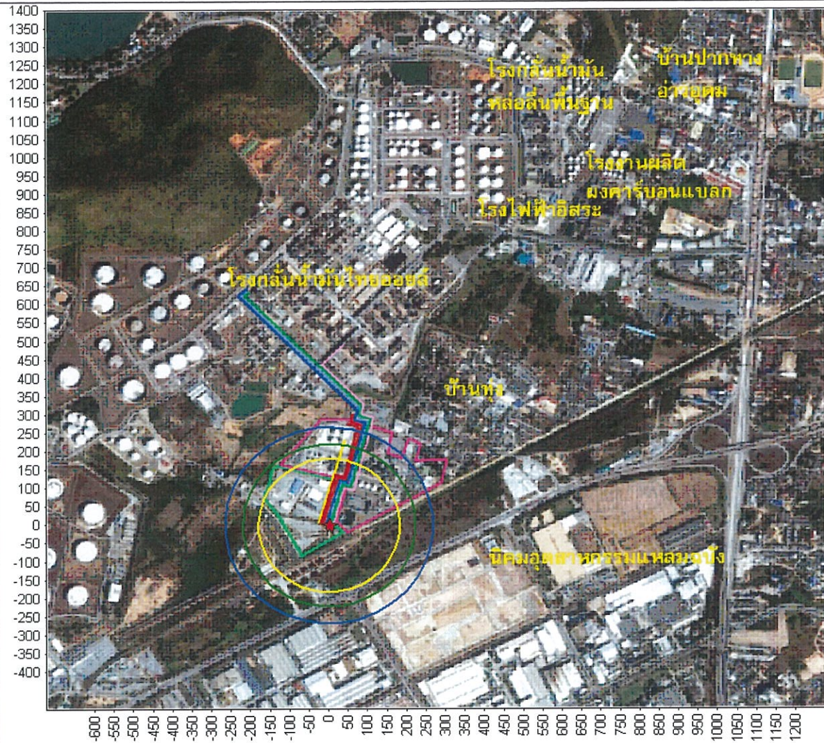
รูปที่ 5.7-13 รัศมีของผลกระทบจากความร้อน กรณีเกิดการติดไฟในลักษณะ Jet Fire จากการรั่วไหลของ Blended Kerosene จากท่อขนส่ง ที่มีแนวท่อจากหน่วยผลิตของโครงการฯ ไปยังโรงกลั่นน้ำมันไทยออยล์ (บริเวณเชื่อมต่อกับหน่วยผลิตของโครงการฯ) ในสภาพบรรยากาศแบบ D-Class (S-2L, 5/D)
