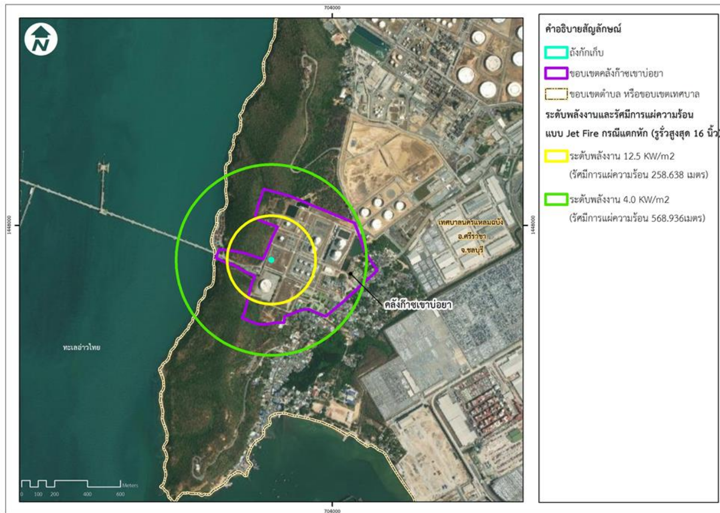
รูปที่ 4.6-5 ขอบเขตผลกระทบกรณีเกิดการรั่วไหลและติดไฟแบบ Jet Fire กรณีท่อแตกหัก (ขนาด 16 นิ้ว)
