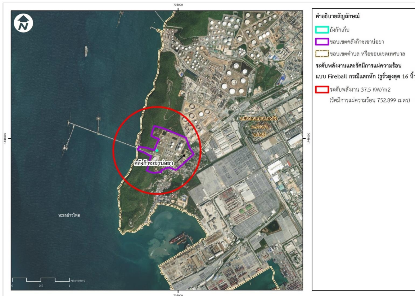
รูปที่ 4.6-10 ขอบเขตรัศมีพลังงานความร้อนที่ระดับ 37.5 kW/m 2 กรณีเกิดการรั่วไหลและติดไฟแบบ Fireball ของถังกักเก็บก๊าซ Propane ของโครงการ (กรณีเลวร้ายที่สุด)
