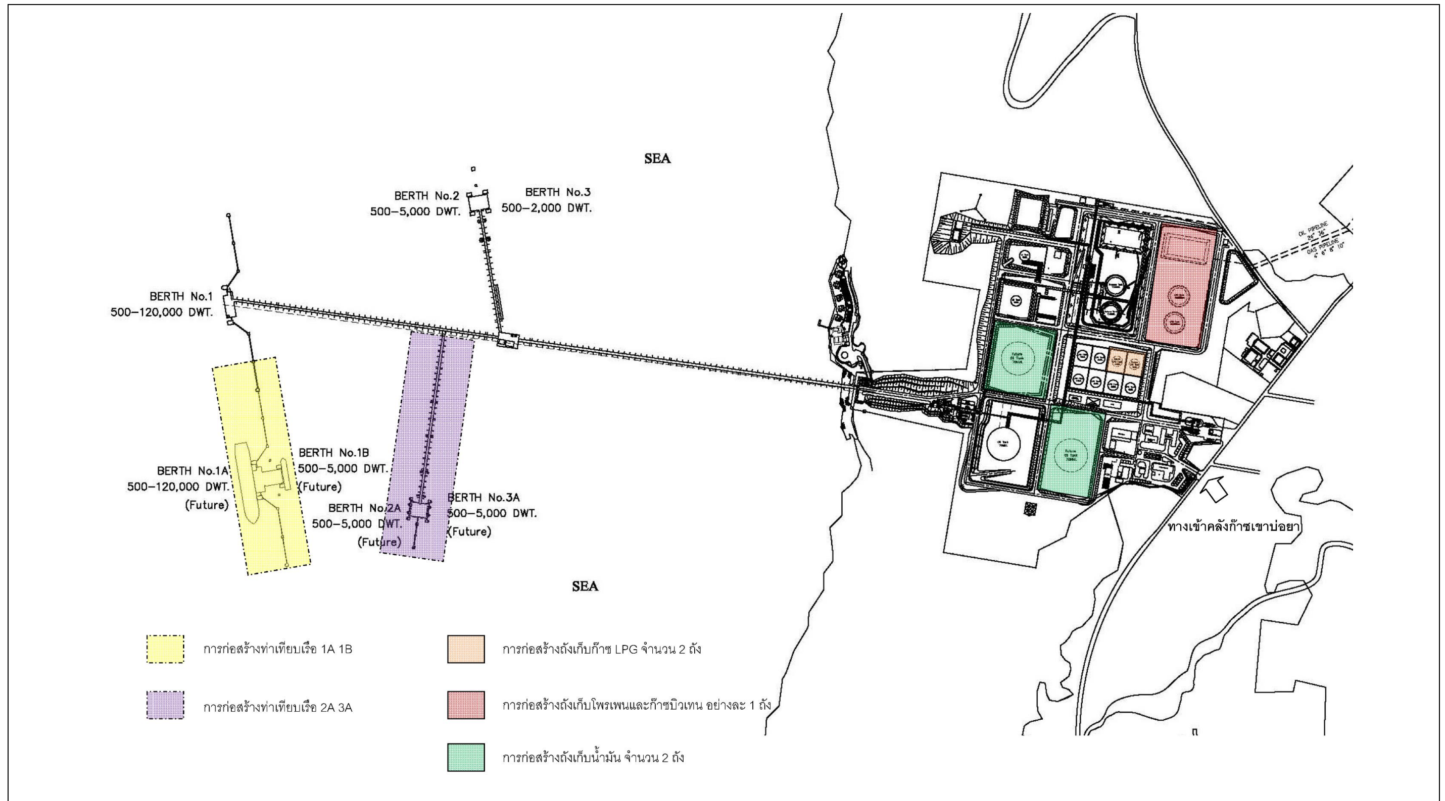
รูปที่ 1.3-1 แผนผังแสดงตำแหน่งท่าเทียบเรือของคลังก๊าซเชาบ่อยาที่ได้รับความเห็นชอบในรายงานการวิเคราะห์ผลกระทบสิ่งแวดล้อม ปี พ.ศ. 2556
