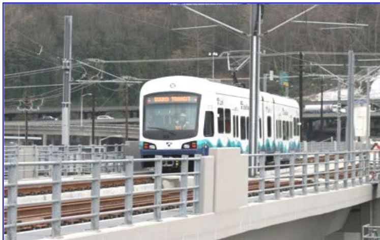
รถไฟฟ้าขนส่งมวลชนขนาดเบา (LRT) บนโครงสร้างทางวิ่งยกระดับ โดยใช้ระบบป้อนกระแสไฟฟ้าจาก Overhead Cable
