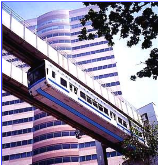
รถไฟฟ้ารางเดี่ยวแบบแขวน (Suspended Monorail) ตัวรถจะขับเคลื่อนไปด้วยล้อที่แขวนอยู่ภายในรางบังคับล้อ มีทั้งระบบล้อยางวิ่งอยู่ภายในร่องรางบังคับ
