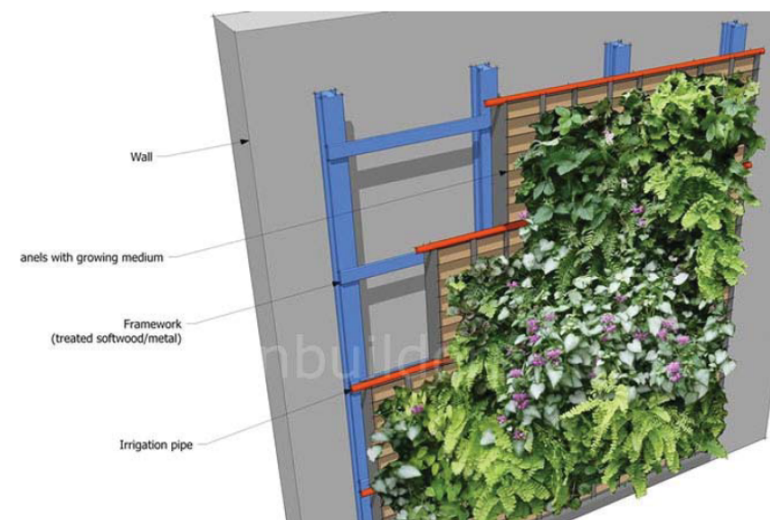
รูปที่ 4.2-6 แบบขยายแสดงตัวอย่างการจัดทำ Green wall (4)
