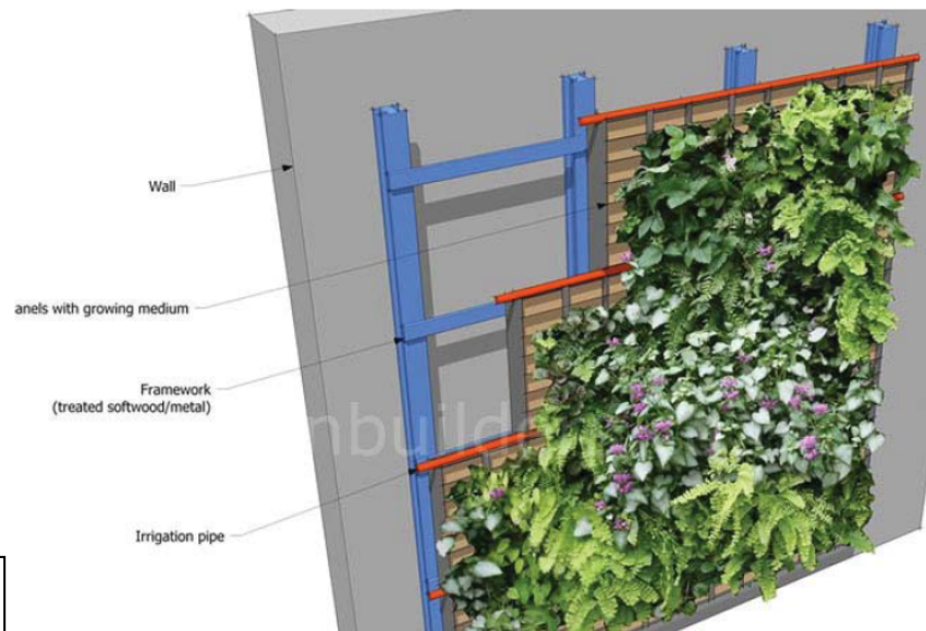
รูปที่ 3.5-13 แบบขยายแสดงตัวอย่างการจัดทำ Green wall (3)
