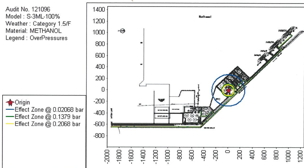
รูปที่ 5.4.3.4-5 รัศมีของผลกระทบจากแรงดัน กรณีเกิดการติดไฟและระเบิดในลักษณะ UVCE จากการรั่วไหลของเมทานอล จากท่าเทียบเรือที่ 2A ไปยังถัง T-0502 ของบริษัท ไทยแทงค์เทอร์มินัล จำกัด ที่ขนาดรั่ว 100% ของขนาดท่อลำเลียง ในสภาพบรรยากาศแบบ F-Class (S-3ML-100%, 1.5/F)
