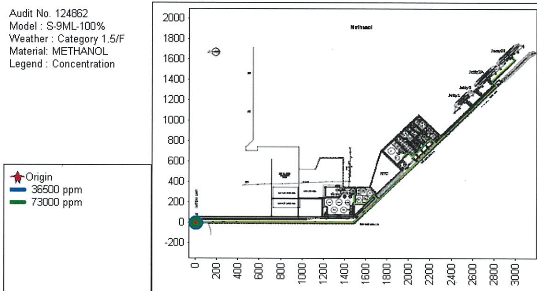
รูปที่ 5.4.3.4-12 รัศมีของผลกระทบจากความร้อน กรณีเกิดการติดไฟในลักษณะ Flash Fire จากการรั่วไหลของเมทานอล จากถัง T-1401 ไปยัง Battery Limit ของบริษัท ไทยแทงค์เทอร์มินัล จำกัด ที่ขนาดรั้ว 100% ของขนาดท่อลำเลียง ในสภาพบรรยากาศแบบ F-Class (S-9ML-100%, 1.5/F)
