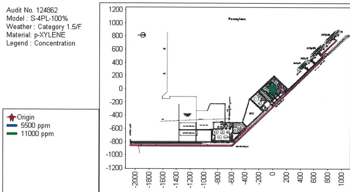
รูปที่ 5.4.3.4-18 รัศมีของผลกระทบจากความร้อน กรณีเกิดการติดไฟในลักษณะ Flash Fire จากการรั่วไหลของพาราไซลีน จากท่าเทียบเรือที่ 2A ไปยังถัง T-3705 ของบริษัท ไทยแทงค์เทอร์มินัล จำกัด ที่ขนาดรั้ว 100% ของขนาดท่อลำเลียง ในสภาพบรรยากาศแบบ F-Class (S-4PL-100%, 1.5/F)
