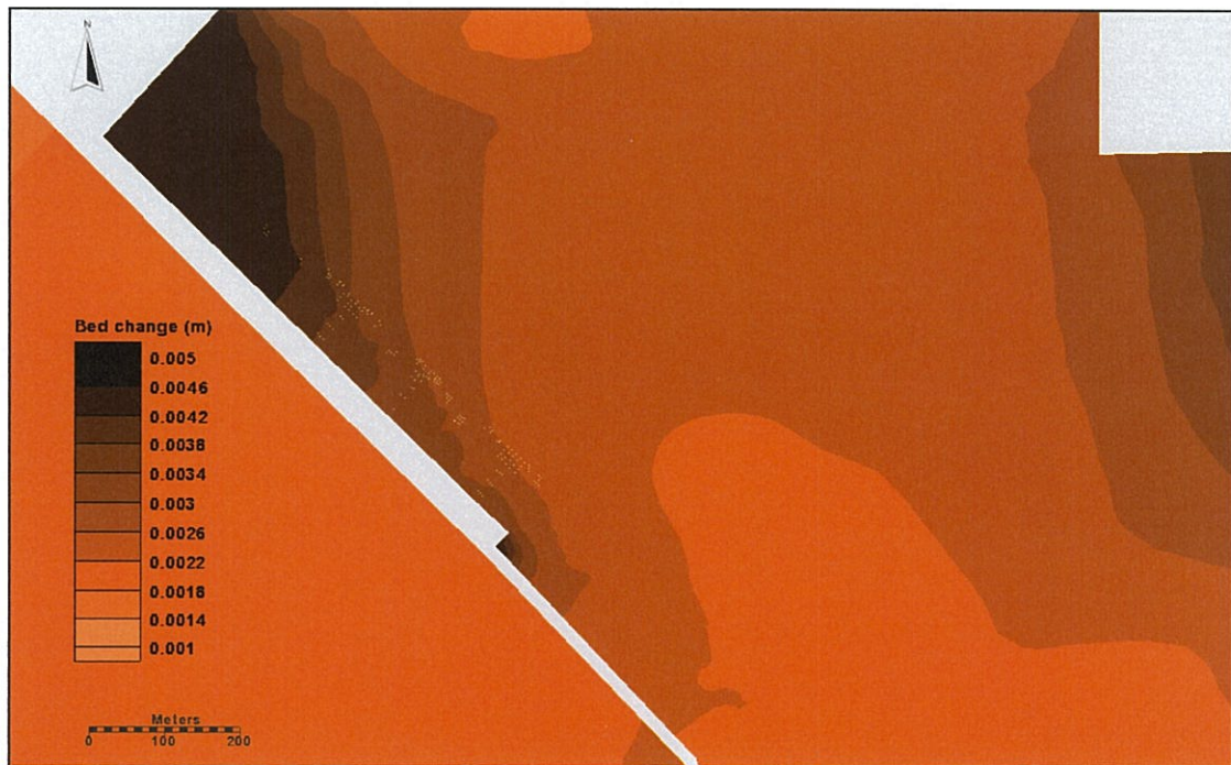
รูปที่ 5.1.3.2-14 การทับถมของตะกอน ประเภท Silt ในส่วนของท่าเทียบเรือเดิมของ TTT กรณีไม่มีท่าเทียบเรือที่ 2B
