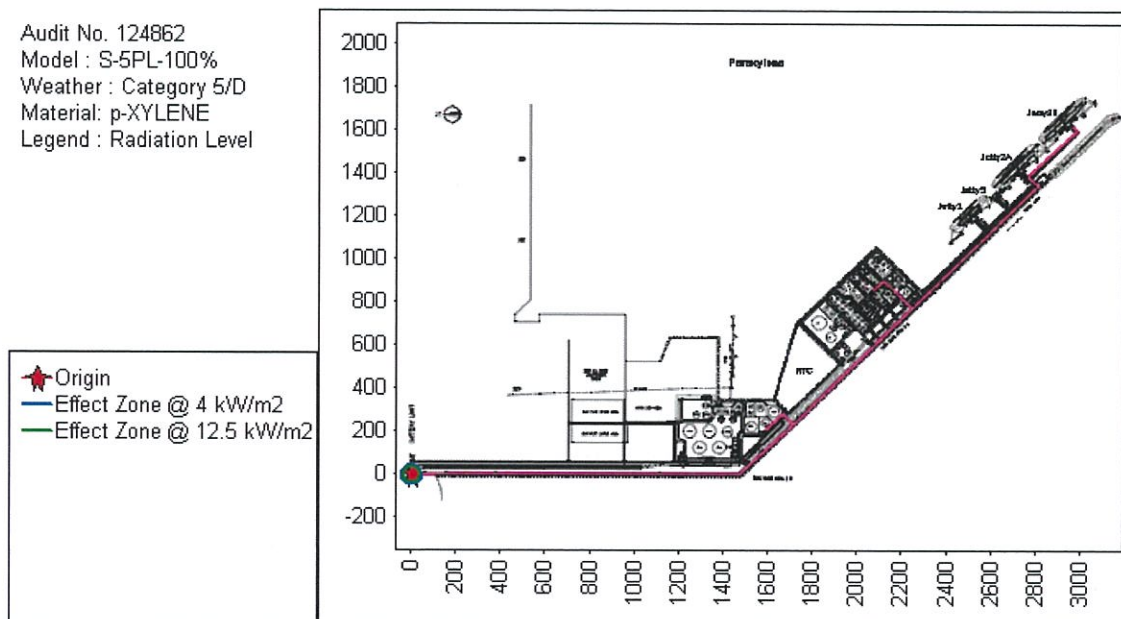
รูปที่ 5.4.3.4-19 รัศมีของผลกระทบจากความร้อน กรณีเกิดการติดไฟในลักษณะ Jet Fire จากการรั่วไหลของพาราไซลีน จากถัง T-1501 ไปยัง Battery Limit ของบริษัท ไทยแทงค์เทอร์มินัล จำกัด ที่ขนาดรั้ว 100% ของขนาดท่อลำเลียง ในสภาพบรรยากาศแบบ D-Class (S-5PL-100%, 5/D)
