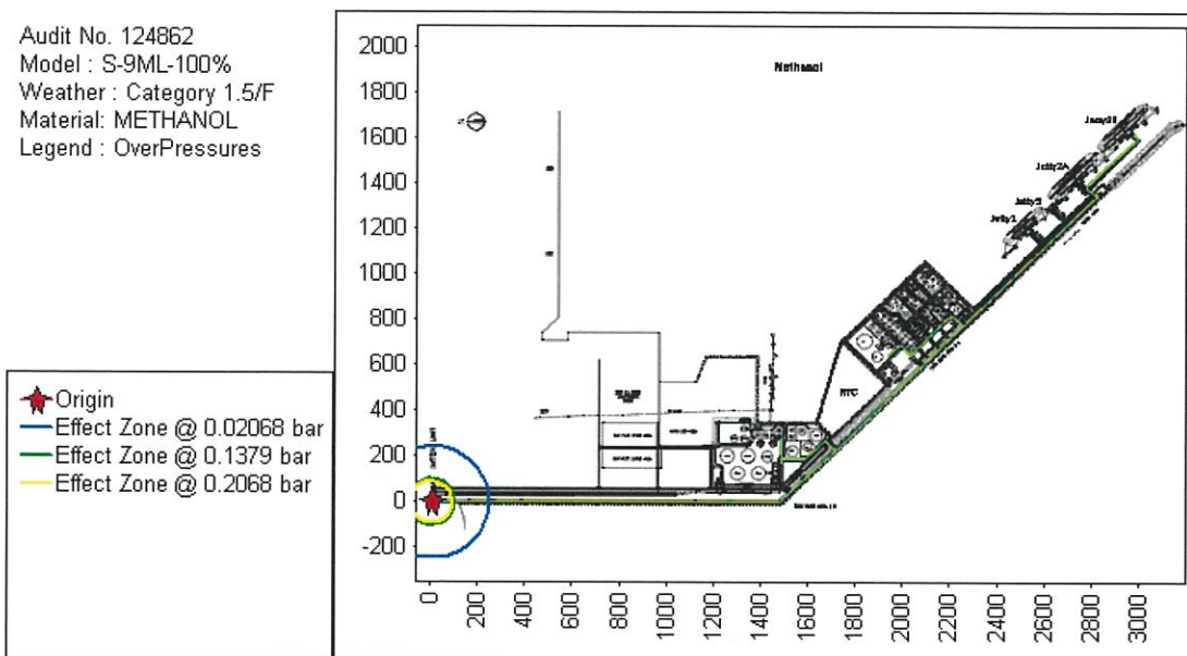
รูปที่ 5.4.3.4-11 รัศมีของผลกระทบจากแรงดัน กรณีเกิดการติดไฟและระเบิดในลักษณะ UVCE จากการรั่วไหลของเมทานอล จากถัง T-1401 ไปยัง Battery Limit ของบริษัท ไทยแทงค์เทอร์มินัล จำกัด ที่ขนาดรั้ว 100% ของขนาดท่อลำเลียง ในสภาพบรรยากาศแบบ F-Class (S-9ML-100%, 1.5/F)
