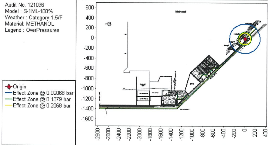
รูปที่ 5.4.3.4-1 รัศมีของผลกระทบจากแรงดัน กรณีเกิดการติดไฟและระเบิดในลักษณะ UVCE จากการรั่วไหลของเมทานอล จากท่าเทียบเรือที่ 2B ไปยังท่าเทียบเรือที่ 2A ของบริษัท ไทยแทงค์เทอร์มินัล จำกัด ที่ขนาดรั่ว 100% ของขนาดท่อลำเลียง ในสภาพบรรยากาศแบบ F-Class (S-1ML-100%, 1.5/F)
