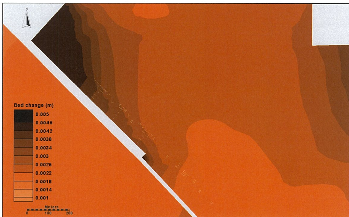
รูปที่ 5.1.3.2-15 การทับถมและการกัดเซาะของตะกอน ประเภท Silt ของท่าเทียบเรือของ TTT กรณีมีท่าเทียบเรือที่ 2B
