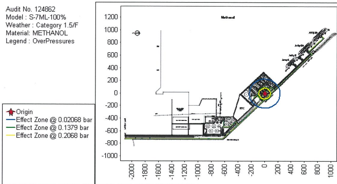
รูปที่ 5.4.3.4-8 รัศมีของผลกระทบจากแรงดัน กรณีเกิดการติดไฟและระเบิดในลักษณะ UVCE
