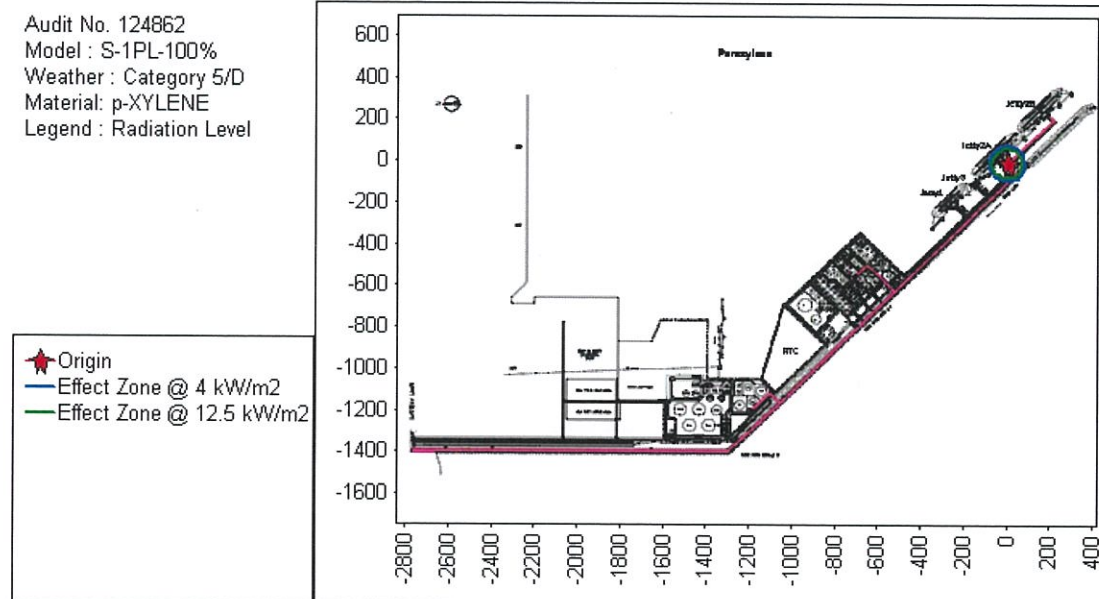
รูปที่ 5.4.3.4-13 รัศมีของผลกระทบจากความร้อน กรณีเกิดการติดไฟในลักษณะ Jet Fire จากการรั่วไหลของพาราไซลีน จากท่าเทียบเรือที่ 2B ไปยังท่าเทียบเรือที่ 2A ของบริษัท ไทยแทงค์เทอร์มินัล จำกัด ที่ขนาดรั้ว 100% ของขนาดท่อลำเลียง ในสภาพบรรยากาศแบบ D-Class (S-1PL-100%, 5/D)
