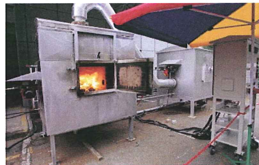
เตาเผาขยะพลาสติกด้วยเชื้อเพลิง Oxy-Hydrogen
