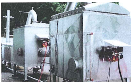
เตาเผาขยะพลาสติกด้วยเชื้อเพลิง Oxy-Hydrogen
