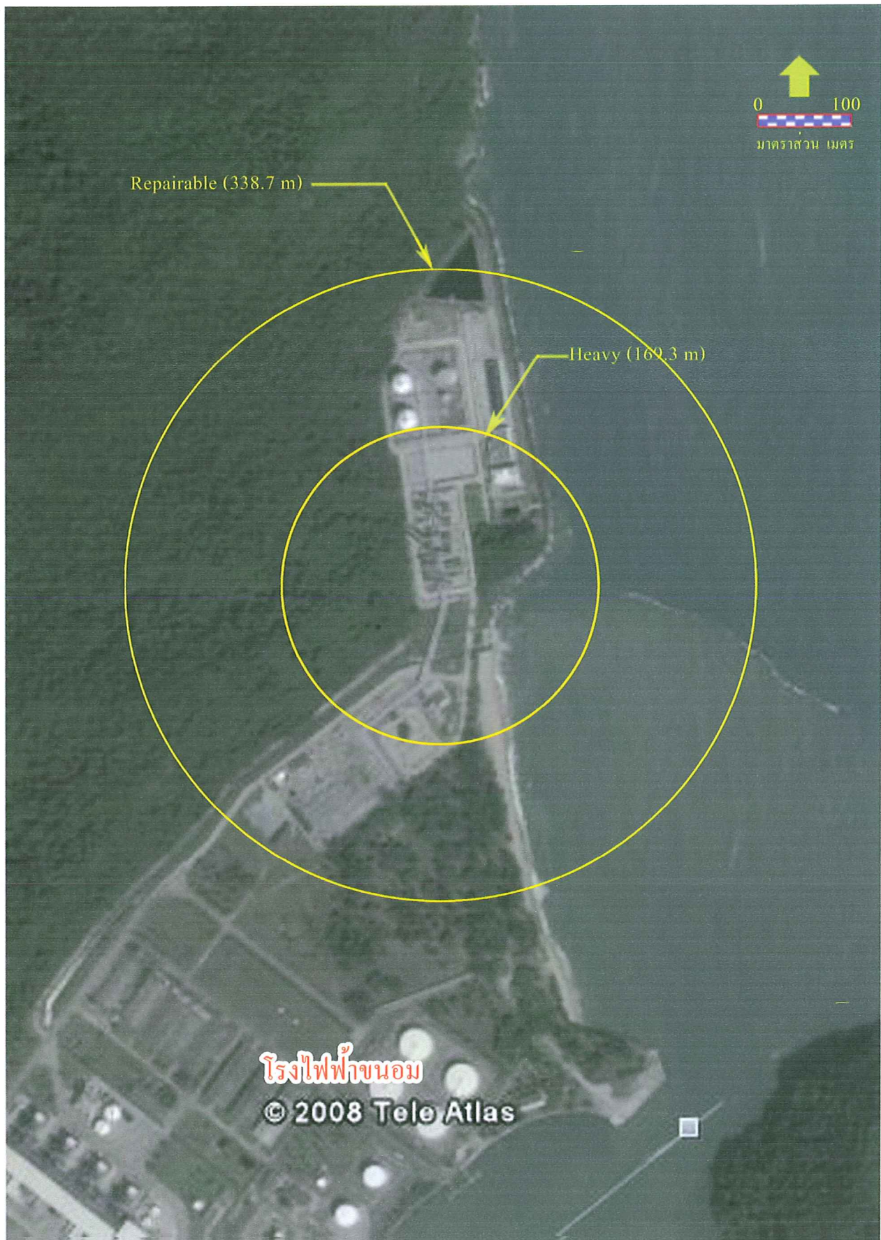
รูปที่ 3.13.2-2 ระยะทางที่ได้รับผลกระทบจากแรงดันอัดจากการระเบิด กรณีเกิดการรั่วไหลมากของ Condensate บริเวณหน่วย Liquid Mercury Adsorber
