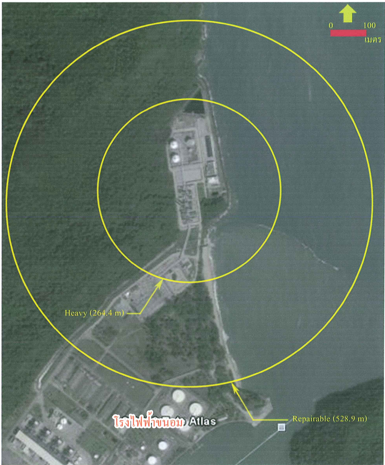
รูปที่ 3.13.2-6 ระยะทางที่ได้รับผลกระทบจากแรงดันอัดจากการระเบิด กรณีเกิดการรั่วไหลมากของ Condensate บริเวณหน่วย Boosted LP Sales Gas
