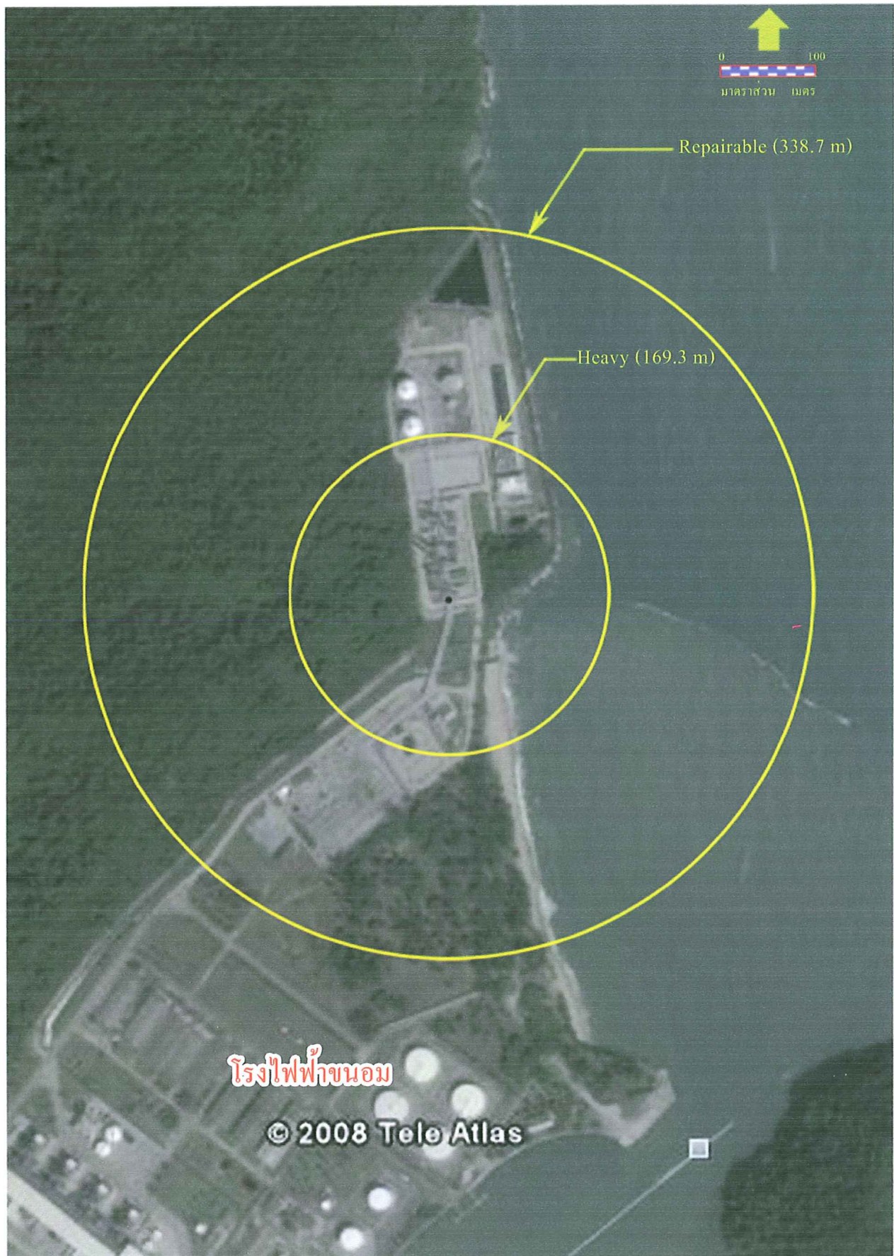
รูปที่ 3.13.2-4 ระยะทางที่ได้รับผลกระทบจากแรงดันอัดจากการระเบิด กรณีเกิดการรั่วไหลมากของ Condensate บริเวณหน่วย Liquid Hydrocarbon
