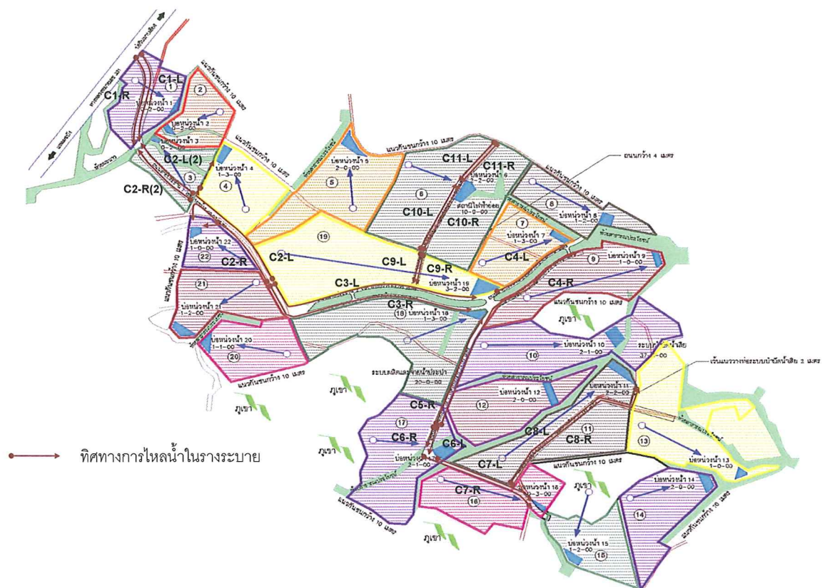
รูปที่ 2.1-1 แนวรางระบายน้ำด้านข้างถนนทั้งสองฝั่งซ้าย-ขวา ของถนนสายประธาน 1, 2 และสายรองประธาน 1, 2, 5
