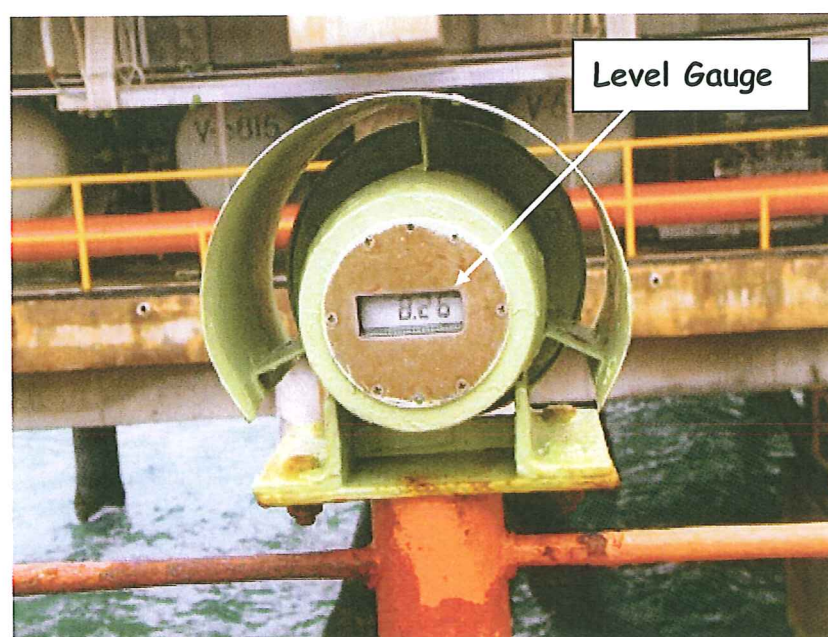
รูปที่ 3.3.1-3 ปัจจุบันโครงการได้ทำการยกเลิกการใช้ Slip Tube สำหรับสารที่มีอันตรายต่อสุขภาพในทุกกรณี โดยปกติเรือทุกลำจะมีเกจวัดระดับ (Level Gauge) ของถังในเรืออยู่แล้ว
