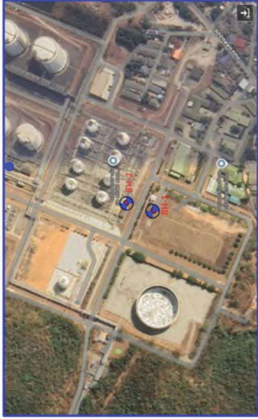
รูปที่ 1 ตำแหน่งของหลุมเจาะ BH-01 และ BH-02 ในแผนผังพื้นที่โครงการเขากาซาบอียา
