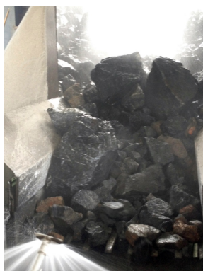
การติดตั้งระบบสเปรย์น้ำบริเวณปากโม่หินใหญ่ และภายในโรงโม่หิน
