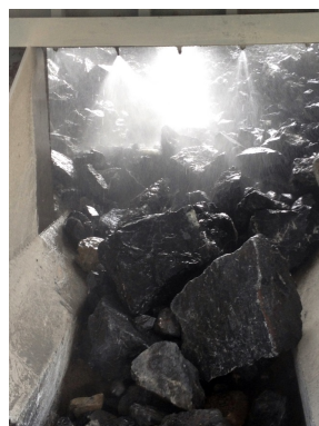
การติดตั้งระบบสเปรย์น้ำบริเวณปากโม่หินใหญ่ และภายในโรงโม่หิน
