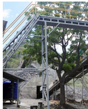
ปิดคลุมเครื่องจักรและสายพานลำเลียงเพื่อลดฝุ่นและเสียง
