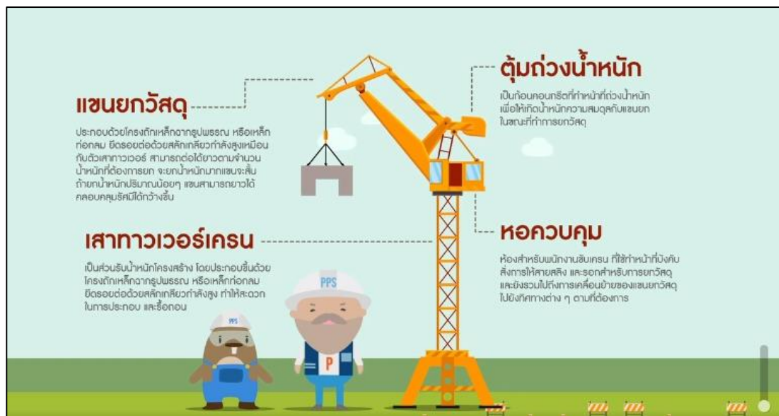
รูปที่ 2.12.3-5 ทาวเวอร์ เครน (Tower crane) แบบบูมกระดก (Luffing Jib Crane)
