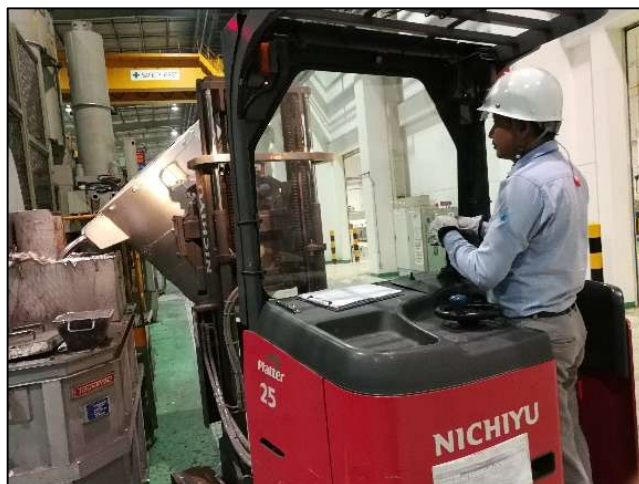
เทน้ำอะลูมิเนียมลง Hopper ของเตาพักหลังเครื่องฉีดขึ้นรูปชิ้นงาน
