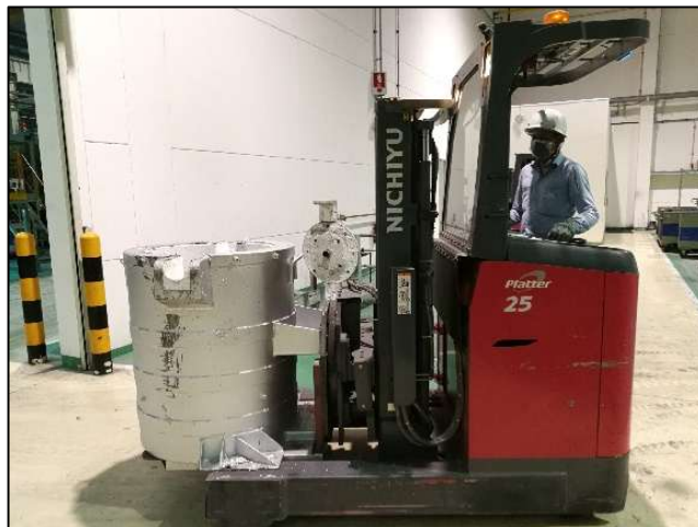
รถยกสำหรับขนส่งน้ำอะลูมิเนียมหลอมเหลว
