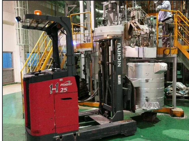
การถ่ายน้ำอะลูมิเนียมหลอมเหลวลงถังรับน้ำอะลูมิเนียม
