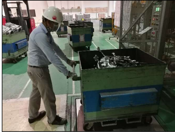
พนักงานเข็นรถเต็มวัตถุดิบ (Basket) เข้าสู่ลิฟต์ขนส่งของเตาหลอมสำหรับเต็มวัตถุดิบ
