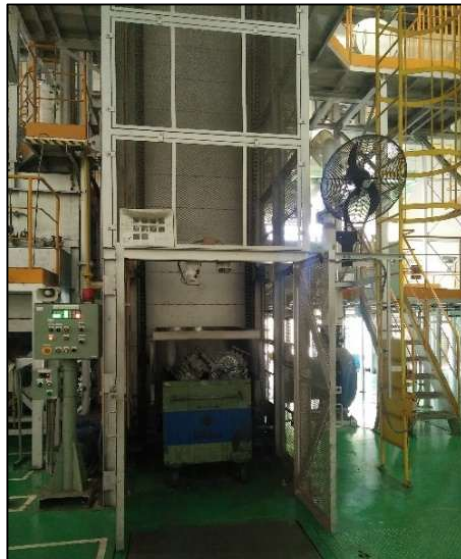
ลิฟต์จะยกและเทวัตถุดิบเต็มใส่ใน Tower โดยระบบอัตโนมัติ
