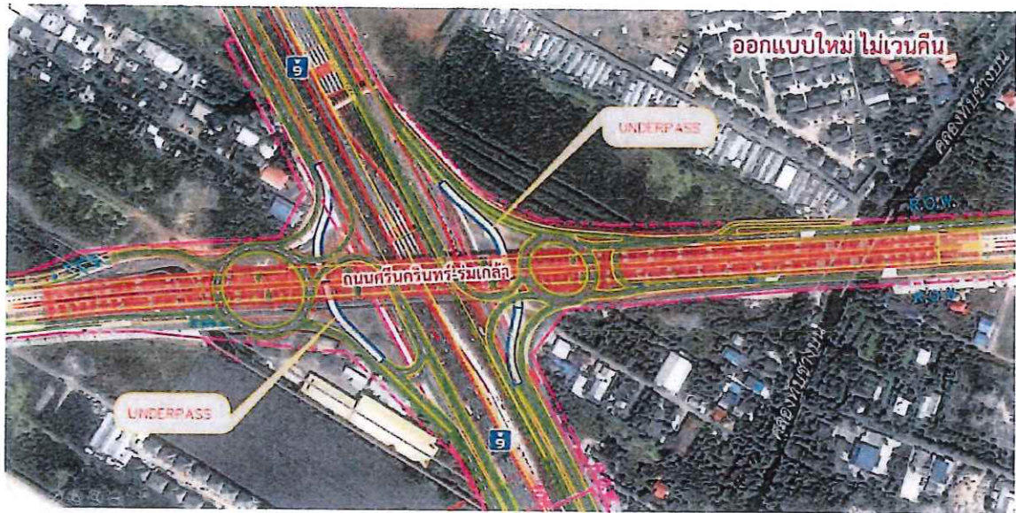
รูปที่ ๑ รูปแบบแนวทางเลือกจุดเชื่อมต่อสะพานสูง รูปแบบที่ ๑ วงเวียนระดับพื้น
