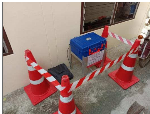
ภาพที่ 3.2-23 การตรวจวัดความสั่นสะเทือน บริเวณชุมชนสะพานสูง (1) ระหว่างวันที่ 24-28 มิถุนายน พ.ศ. 2564
