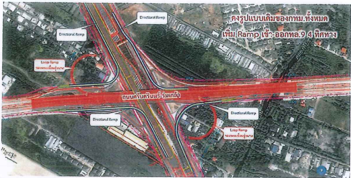
รูปที่ ๓ รูปแบบแนวทางเลือกจุดเชื่อมต่อสะพานสูง รูปแบบที่ ๓ Directional Ramp (เลี้ยวซ้าย)
