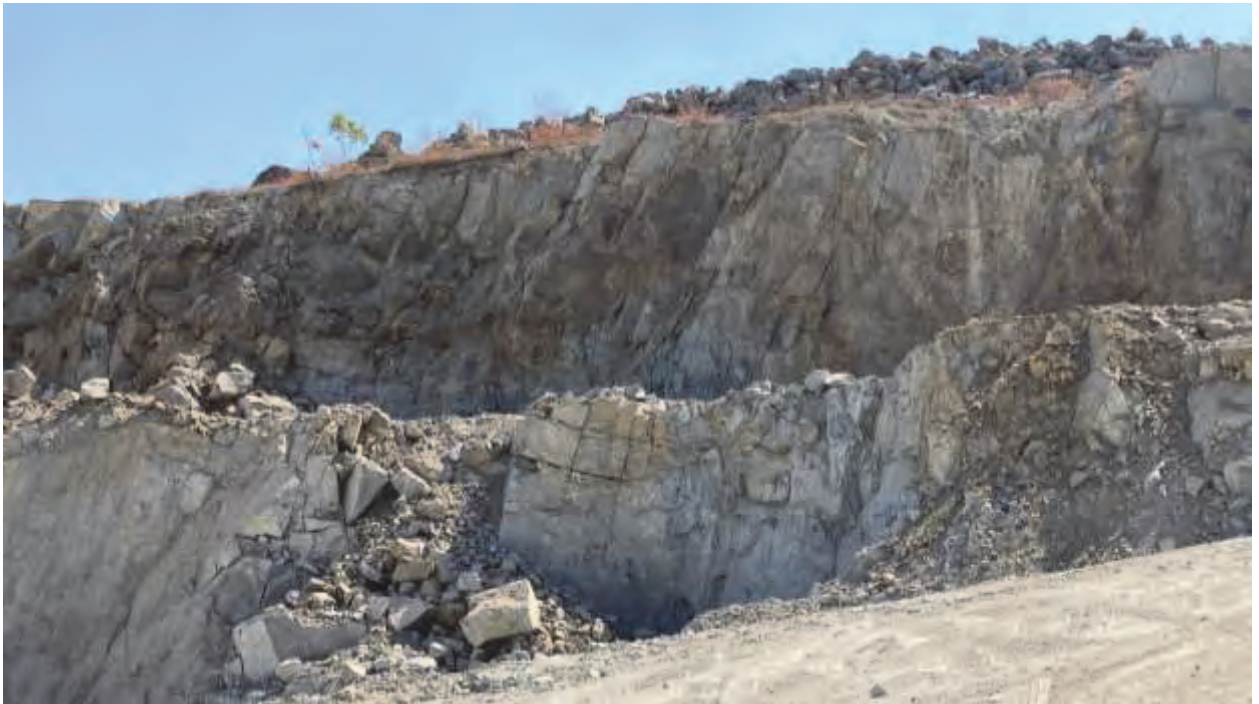
รูปที่ 5 ลักษณะของแนวรอยแตกหลักในมวลหินแกรนิต บริเวณเชิงลาดหน้าเหมืองทางด้านทิศตะวันออก
