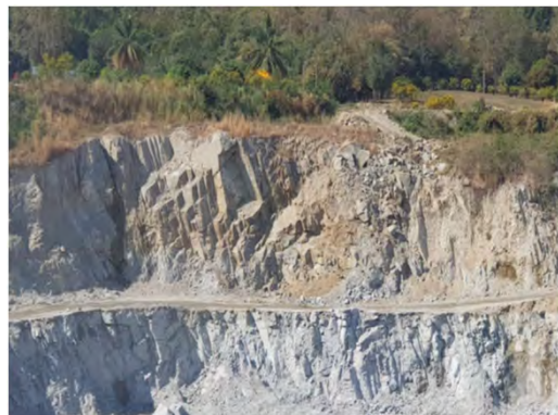
แสดงลักษณะของรอยแตกหลักในหินแกรนิต 2 แนวตัดกันทำให้เกิดการแตกในลักษณะเป็นบล็อก (Block slide) (พิกัดภาพถ่าย 1467568N/728990E มุมมองไปทาง SW)
