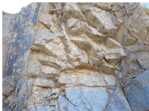
แสดงลักษณะทั่วไปของหินแกรนิตบริเวณช่วงรอยต่อกับเปลือกดิน มีการผุพังเล็กน้อยบริเวณผิวโดยหินแกรนิตที่อยู่ถัดลงมาจะเป็นหินแกรนิตเนื้อสด (พิกัดภาพถ่าย 1467519N/728995E มุมมองไปทาง S)
