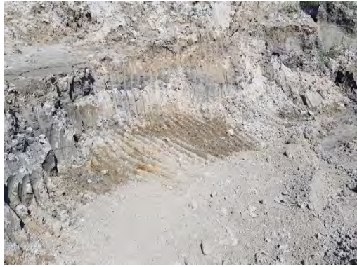
แสดงลักษณะทั่วไปของชั้นเปลือกดินที่เกิดตะกอนที่พัดพามาสะสมปิดทับหินแกรนิตในพื้นที่โครงการ (พิกัดภาพถ่าย 1467802N/729074E มุมมองไปทาง W)
