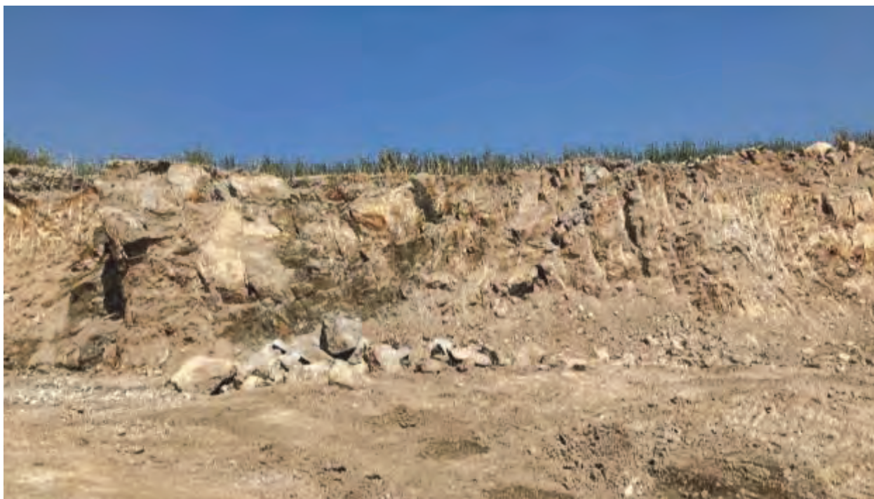
รูปที่ 7 ลักษณะหินแกรนิตผุที่พบในพื้นที่โครงการ
