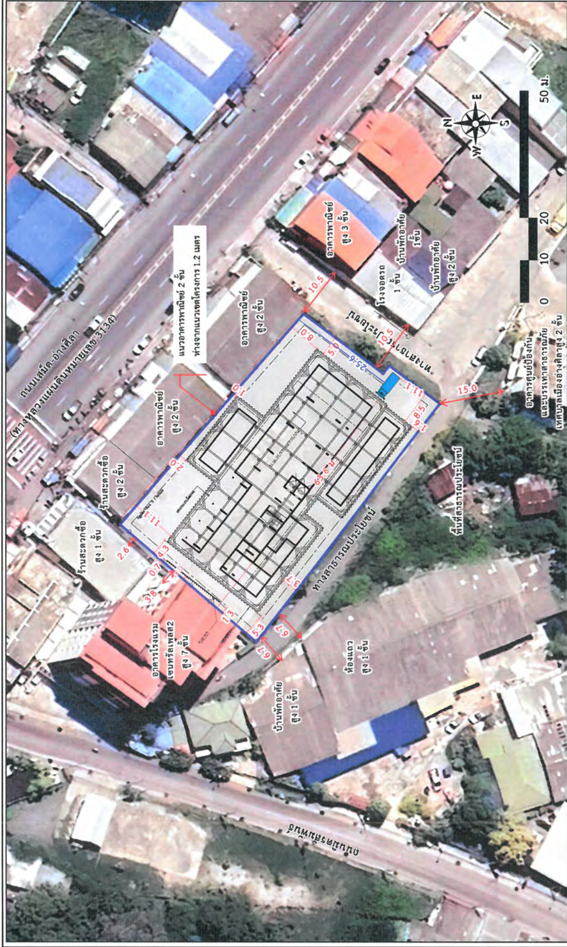
รูปที่ 4.1.6-1 ฝั่งแสดงระยะห่างจากแนวผนังกันดิน (Sheet Pile) และจุดจุดจอตระปรทุกช่วงฐานรากกับแนวอาคารข้างเคียง
