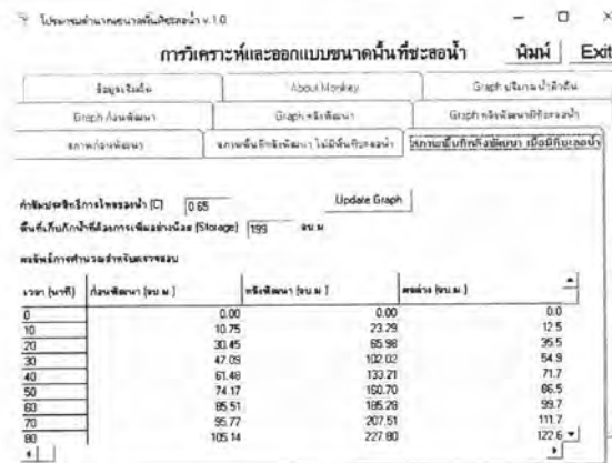
รูปที่ 3 แสดงผลการคำนวณปริมาณน้ำฝน และอัตราการไหลน้ำผิวดินหลังพัฒนาเมื่อมีพื้นที่ชะลอน้ำ
