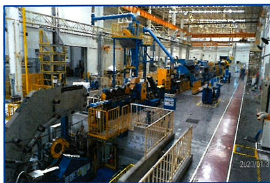
(ค) เครื่องหล่ออลูมิเนียม (Continuous Casting Machine) และเครื่องรีดลดขนาดแบบหยาบ (Roughing Mill)
