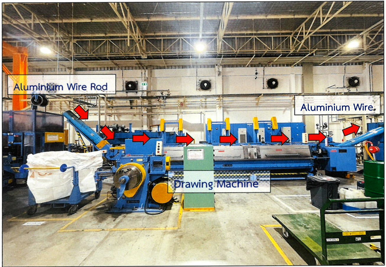
ภาพถ่ายที่ 2.5.1-1 ตัวอย่างลักษณะของเครื่องยัดและม้วน (Drawing Machine) ที่จะติดตั้งเพิ่มเติมภายหลังการเปลี่ยนแปลงฯ
