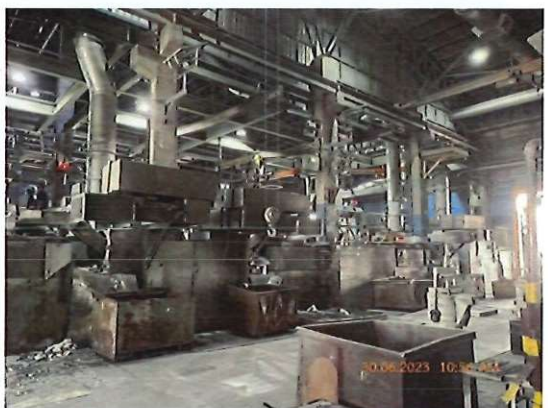
ภาพที่ 18 เตาหลอมแบบเหนี่ยวนำไฟฟ้า (เตาหลอมหลัก)
