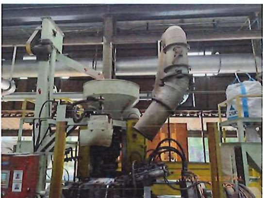
ภาพที่ 17 ระบบรวบรวมอากาศด้านบนเครื่อง shell core
