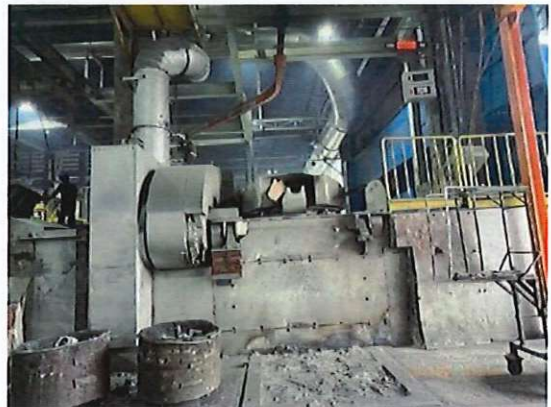
ภาพที่ 34 เตาหลอมแบบเหนียวไฟฟ้า (เตาหลอมสำรอง)
